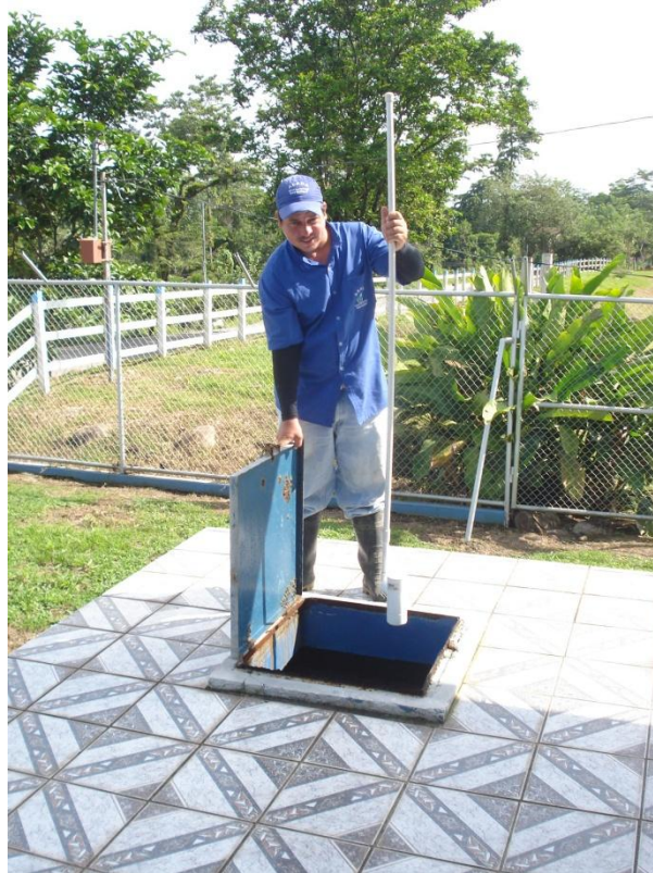
Figura 9. Obtención de la muestra para medición de cloro residual
