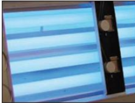
Figura 2. Montaje de las lámparas fluorescentes junto con el sistema de controlador de irradiación. Costa Rica; 2010.
