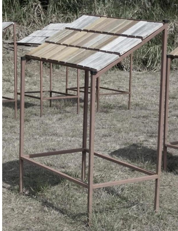
Figura 2. Diseño del caballete utilizado para la ubicación de las unidades experimentales de A. mangium , C. odorata y T. grandis , expuestas al intemperismo natural.
