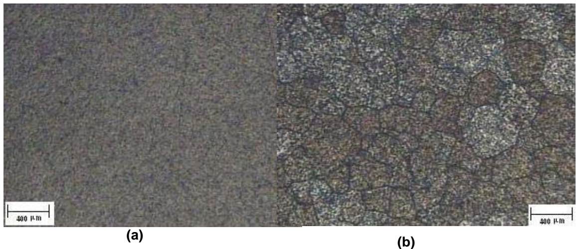
Figura IV-32 Sección transversal de la aleación 6063T5 extruída a 548,89 °C (1020 °F)
