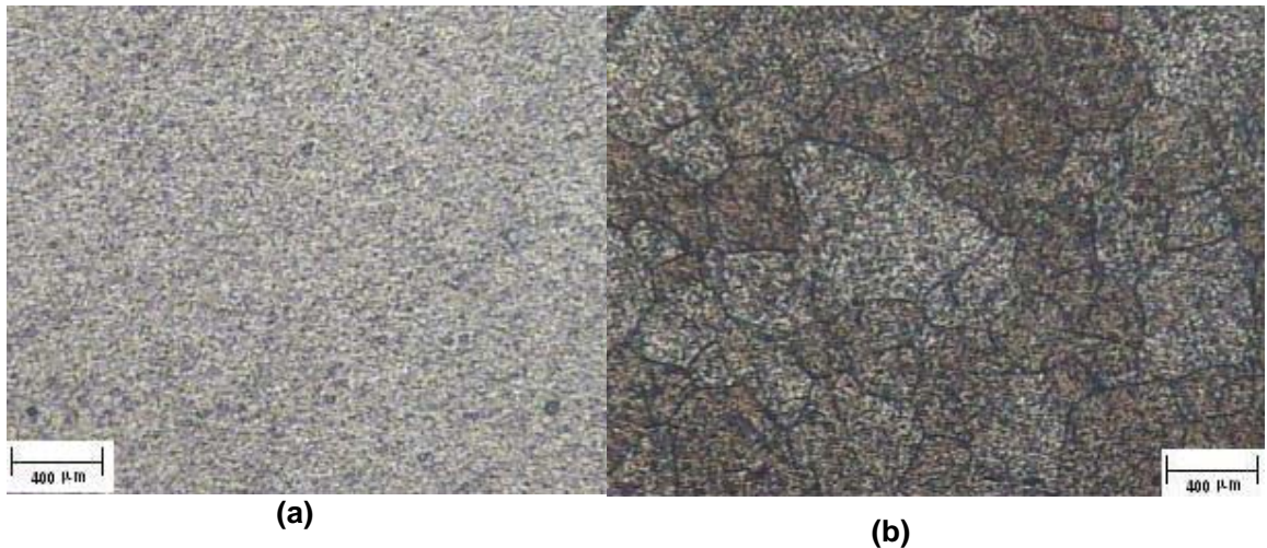
Figura IV-30 Sección transversal de la aleación 6063T5 extruída a 568,89 °C (1056 °F) (a) Microestructura sin aplicar reactivo. Magnitud original: 200x. (b) Microestructura que muestra los límites de grano y su tamaño. Tamaño de grano promedio (índice ASTM): -1. Reactivo: 0,5% HF. Magnitud original: 200x.
