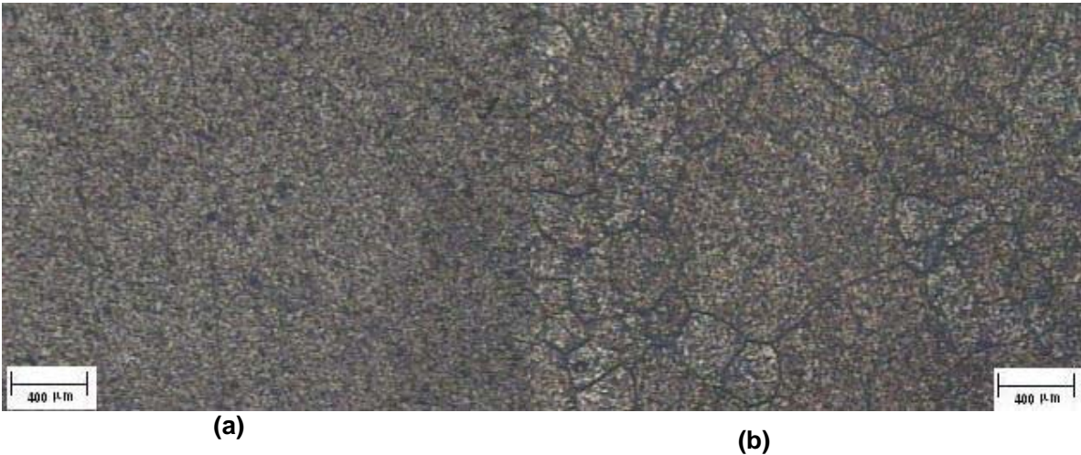
Figura IV-7 Sección superficial de la aleación 6063T5 extruída a 504,44 °C (940 °F) (a) Microestructura sin aplicar reactivo. Magnitud original: 200x. (b) Microestructura que muestra los límites de grano y su tamaño. Reactivo: 0,5% HF. Magnitud original: 200x.
