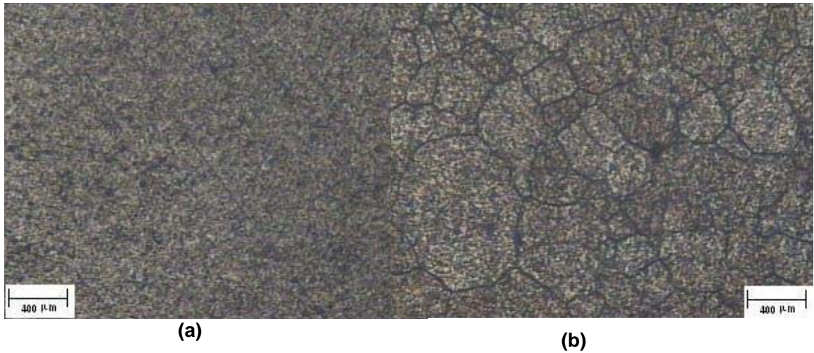
Figura IV-21 Sección superficial de la aleación 6063T5 extruída a 567,22 °C (1053 °F) (a) Microestructura sin aplicar reactivo. Magnitud original: 200x. (b) Microestructura que muestra los límites de grano y su tamaño. Tamaño de grano promedio (índice ASTM): -2. Reactivo: 0,5% HF. Magnitud original: 200x.
