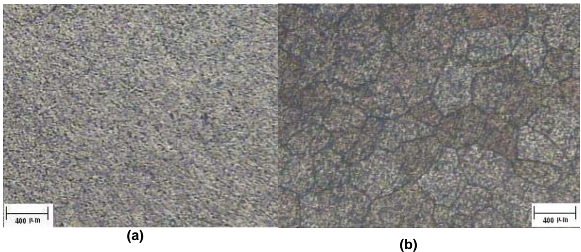
Figura IV-38 Sección transversal de la aleación 6063T5 extruída a 511,67 °C (953 °F).
