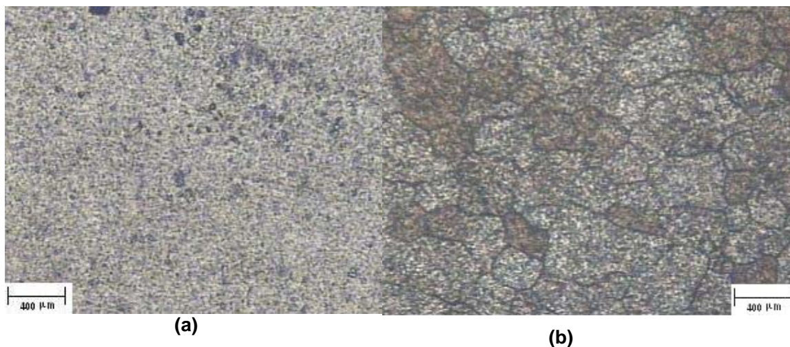
Figura IV-14 Sección transversal de la aleación 6063T5 extruída a 526,11 °C (979 °F)
