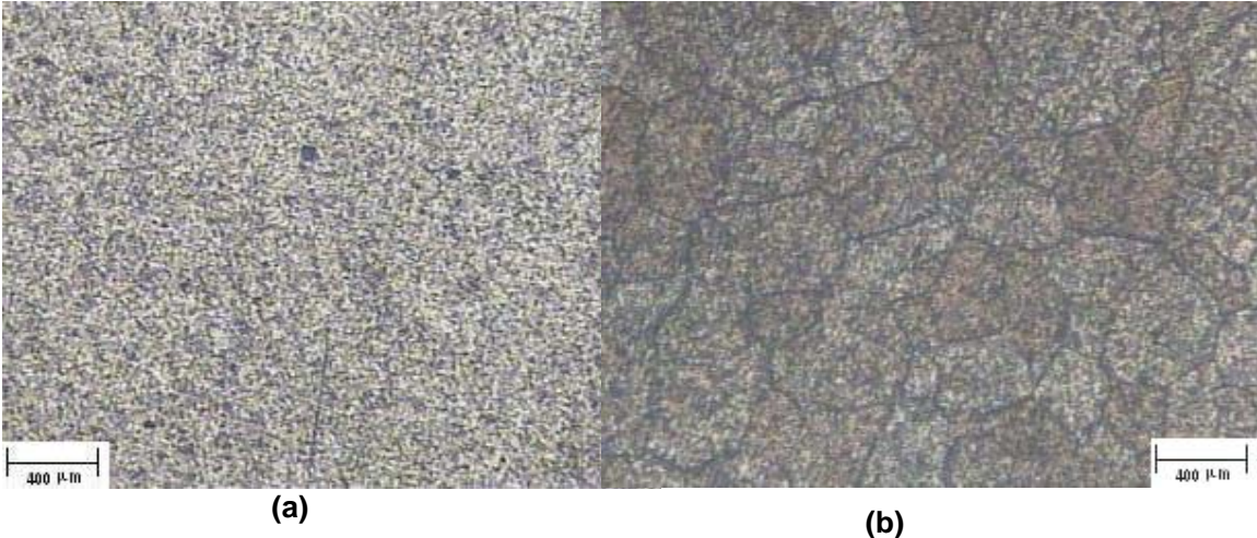
Figura IV-4 Sección transversal de la aleación 6063T5 extruída a 549,44 °C (1021 °F) (a) Microestructura sin aplicar reactivo. Magnitud original: 200x. (b) Microestructura que muestra los límites de grano y su tamaño. Reactivo: 0,5% HF. Magnitud original: 200x.
