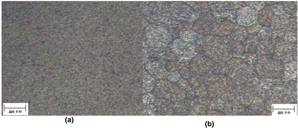
Figura IV-46 Sección transversal de la aleación 6063T5 extruída a 530,56 °C (987 °F) (a) Microestructura sin aplicar reactivo. Magnitud original: 200x. (b) Microestructura que muestra los límites de grano y su tamaño. Tamaño de grano promedio (índice ASTM): -3. Reactivo: 0,5% HF. Magnitud original: 200x.
