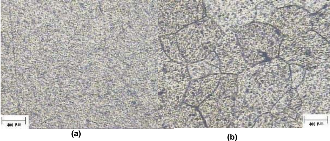
Figura IV-3 Sección superficial de la aleación 6063T5 extruída a 549,44 °C (1021 °F) (a) Microestructura sin aplicar reactivo. Magnitud original: 200x. (b) Microestructura que muestra los límites de grano y su tamaño. Reactivo: 0,5% HF. Magnitud original: 200x.
