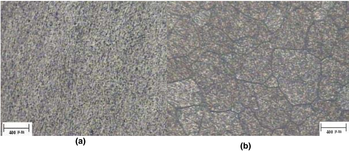
Figura IV-5 Sección superficial de la aleación 6063T5 extruída a 571,11 °C (1060 °F) (a) Microestructura sin aplicar reactivo. Magnitud original: 200x. (b) Microestructura que muestra los límites de grano y su tamaño. Reactivo: 0,5% HF. Magnitud original: 200x.
