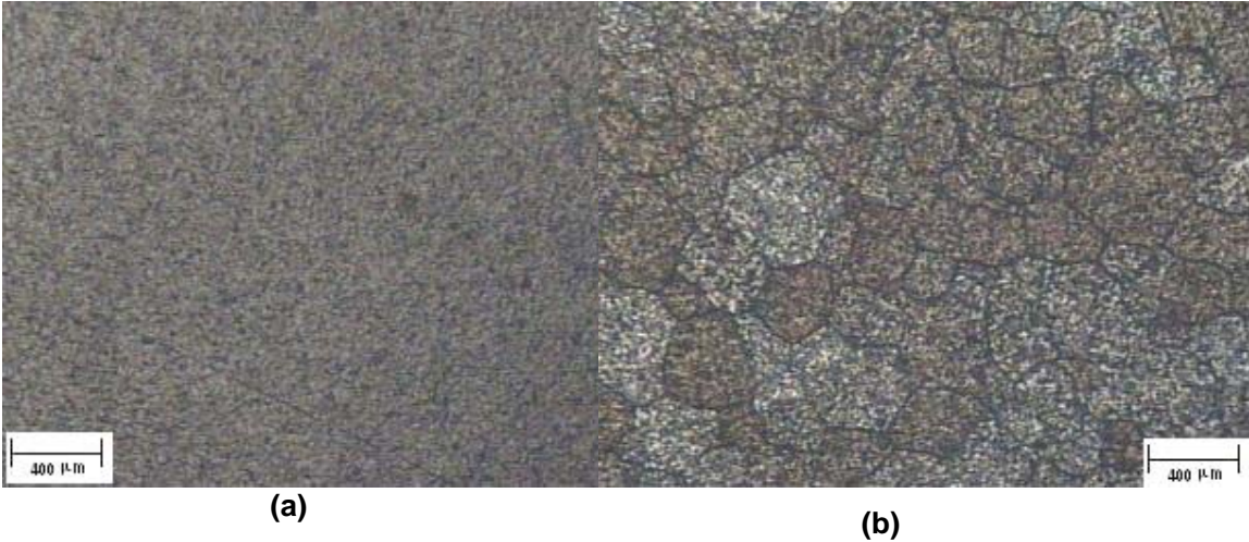
Figura IV-8 Sección transversal de la aleación 6063T5 extruída a 504,44 °C (940 °F)
