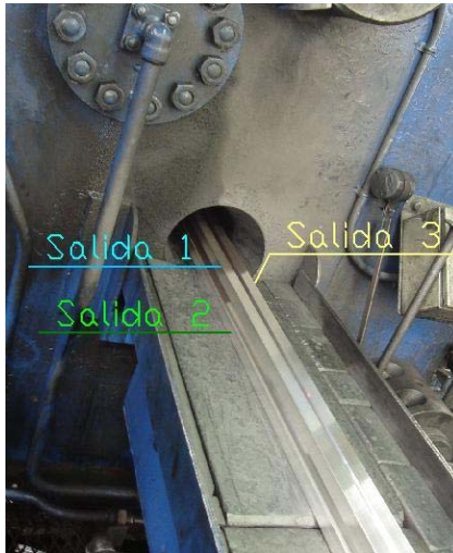
Figura II-3 Salidas de los perfiles de la matriz 1029. Se señalan las cuatro salidas, únicamente se observan 3, la salida 4 está por debajo de la salida 3 y a la par de la salida 2.
