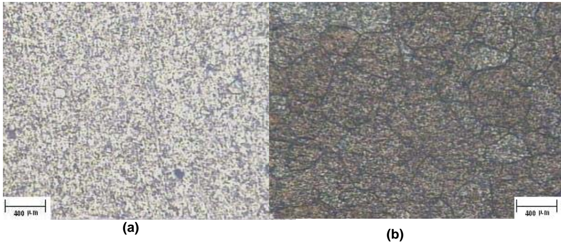
Figura IV-33 Sección superficial de la aleación 6063T5 extruída a 567,78 °C (1054 °F)
