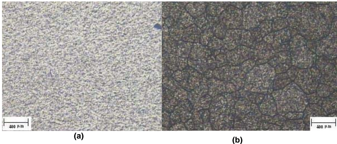
Figura IV-57 Sección superficial de la aleación 6063T5 extruída a 526,11 °C (979 °F)
