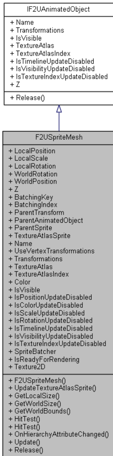
Figura 5.5 Diagrama de clases de F2USpriteMesh
