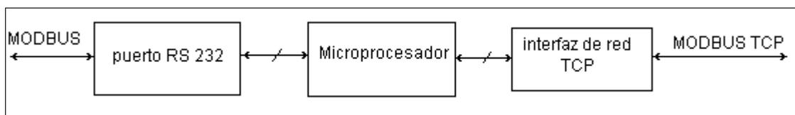
**Figura 2.2** Diagrama de bloques de la solución propuesta.
