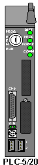
Figura 4.1. Imagen de la vista frontal de un controlador lógico programable PLC-5/20
