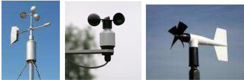
Figura 1. Anemómetros de cazoletas y de propela.
