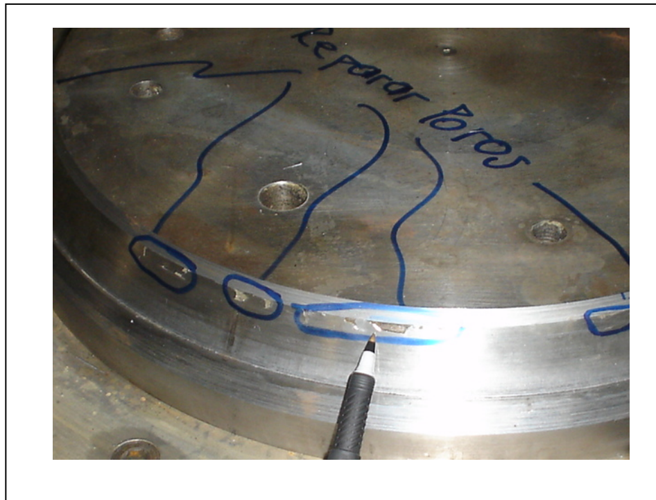
Figura 16. Porosidades en el área de soldadura en la matriz de 400 Metric Pressure.
