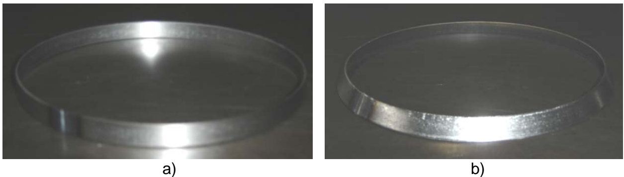
Figura 11. Estampado de fleje en matriz de formado. a) Fleje metálico luego de segundo rolado; b) fleje metálico luego de operación de estampado.
