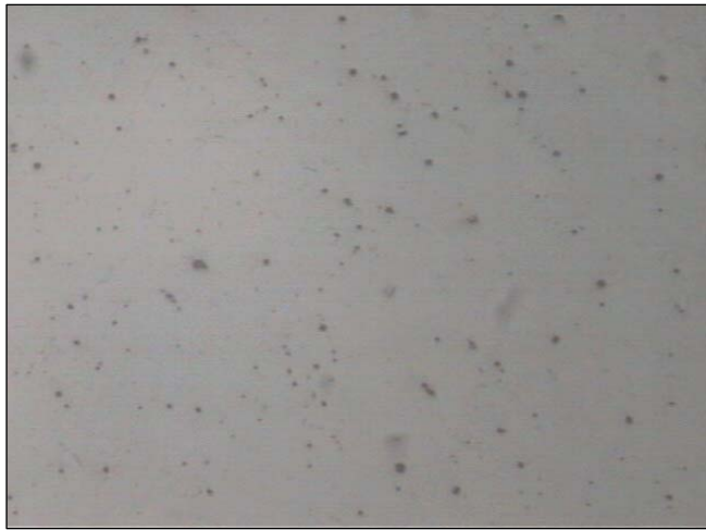
Figura 36. Fotomicrografía de la muestra de acero laminado en frío proveniente de QIYUANG GROUP. a) Superficie de la muestra después del pulido final, amplificado 50x. b) Superficie de la muestra después del ataque químico con Nital 3%. Aumento a 50x.
