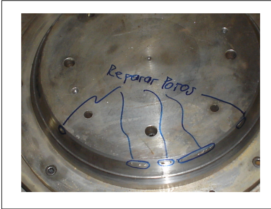
Figura 17. Defectos en la matriz de estampado 400 Metric Pressure. Porosidades en la soldadura aparecieron luego varias operaciones de maquinado.
