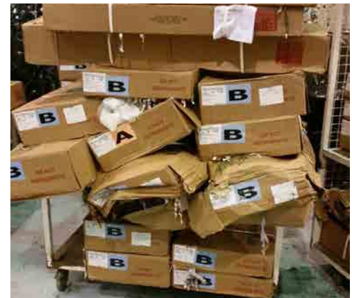
Figura 2.8 Ejemplo de estiba con colapso
