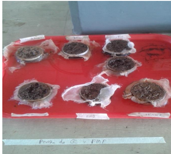
Figura 4. 8 Anillos con malla, liga de hule y suelo reposando sobre agua para saturar el suelo; en una bandeja de plástico.
