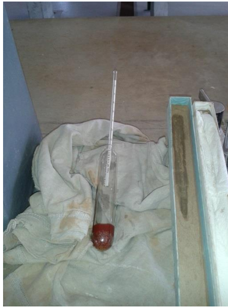
Figura 4. 6 Hidrómetro con el que se tomaron las medidas necesarias para realizar el experimento
