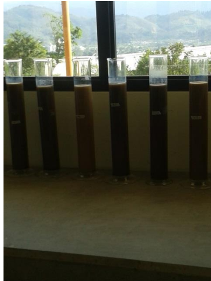
Figura 4. 5 Seis muestras de suelo en el cilindro de Bouyoucus (minutos antes de realizar la prueba)
