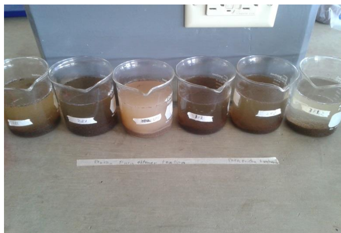
Figura 4. 3 Muestras de suelo con CALGON y agua destilada en beaker de 400 ml cada una
