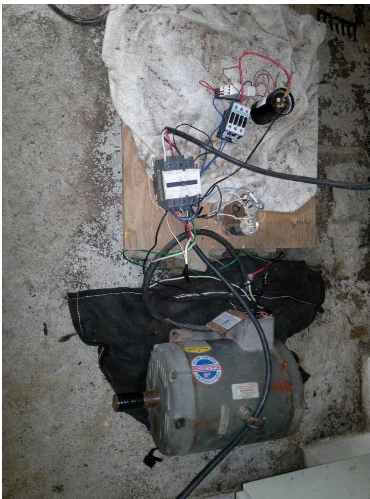
Fotografía 7.1 Motor Esclavo en Circuito Steinmetz.
