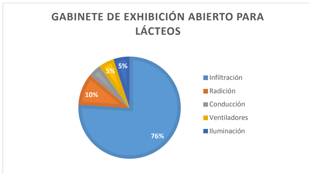
Gráfica 5.1. Distribución porcentual de componentes de carga térmica para gabinete de exhibición abierto
