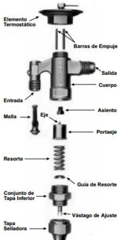
Ilustración 27. Desarme completo de válvula de expansión SPORLAN.
