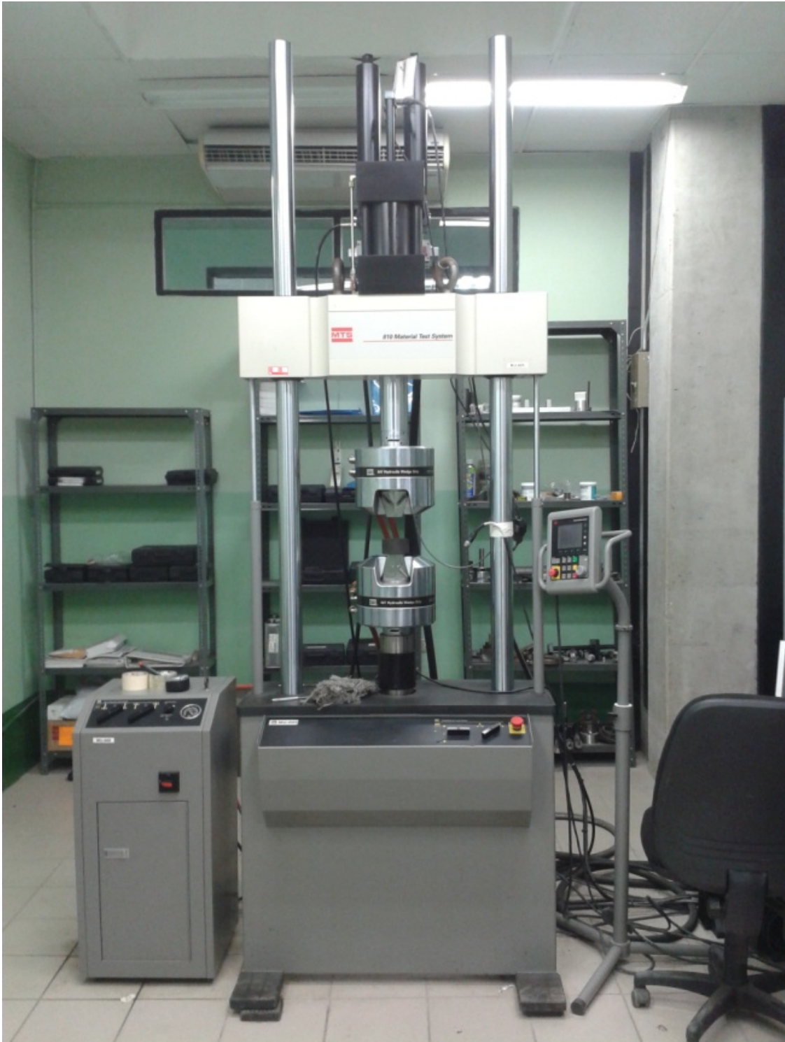
Imagen 20. Celda de carga hidráulica para pruebas de tracción y compresión en materiales marca MTS® modelo 318.25 instalada en el laboratorio de fuerza del LanammeUCR.
