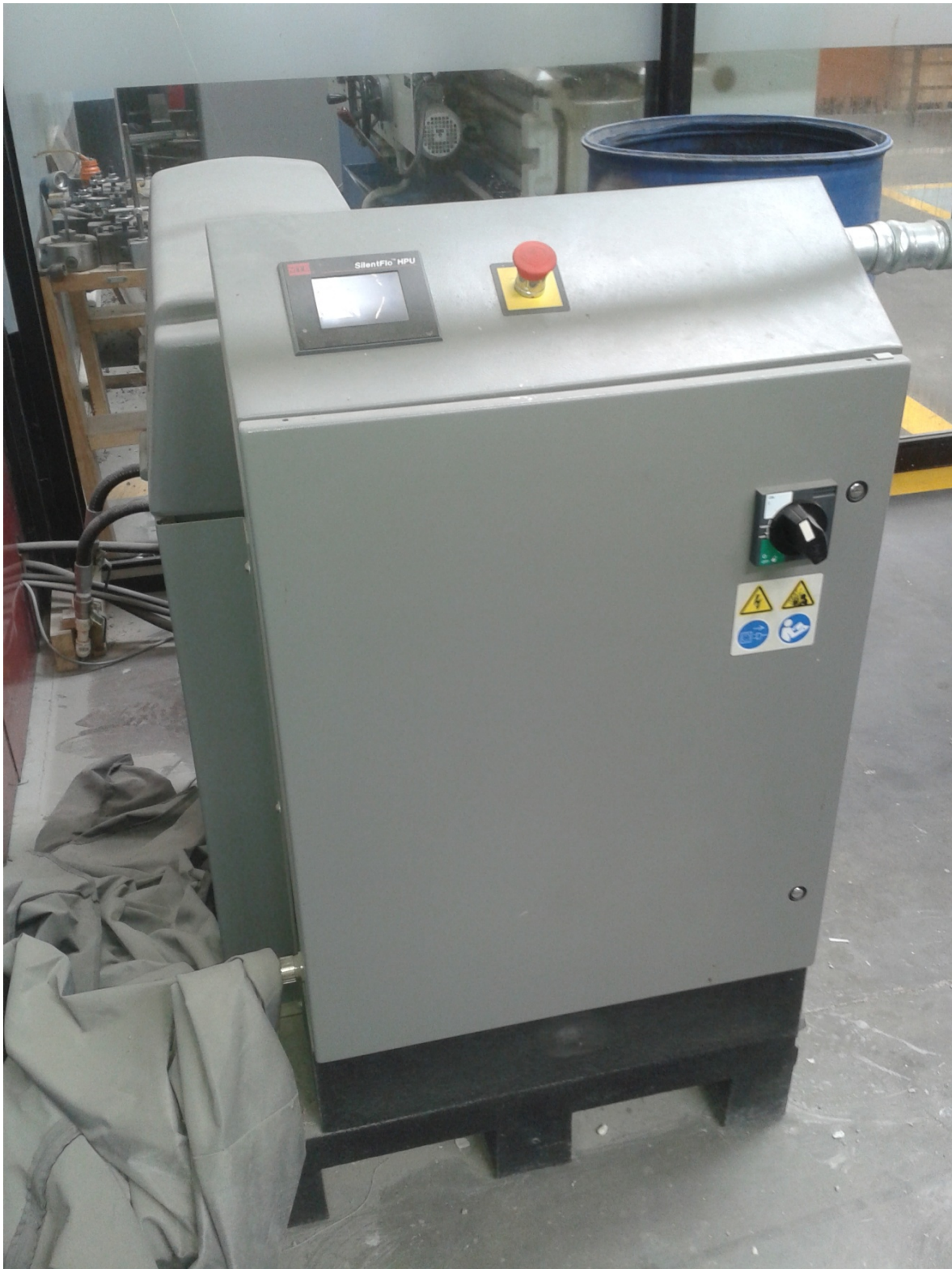
Imagen 23. HPU marca MTS® modelo 505.11-G2 instalada en el laboratorio de fuerza del LanammeUCR.
