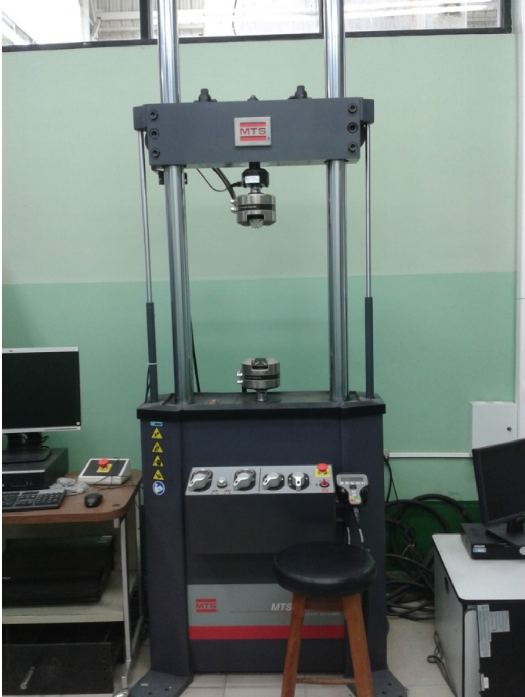
Imagen 19. Celda de carga hidráulica para pruebas de tracción y compresión en materiales marca MTS® modelo 370.10 instalada en el laboratorio de fuerza del LanammeUCR.
