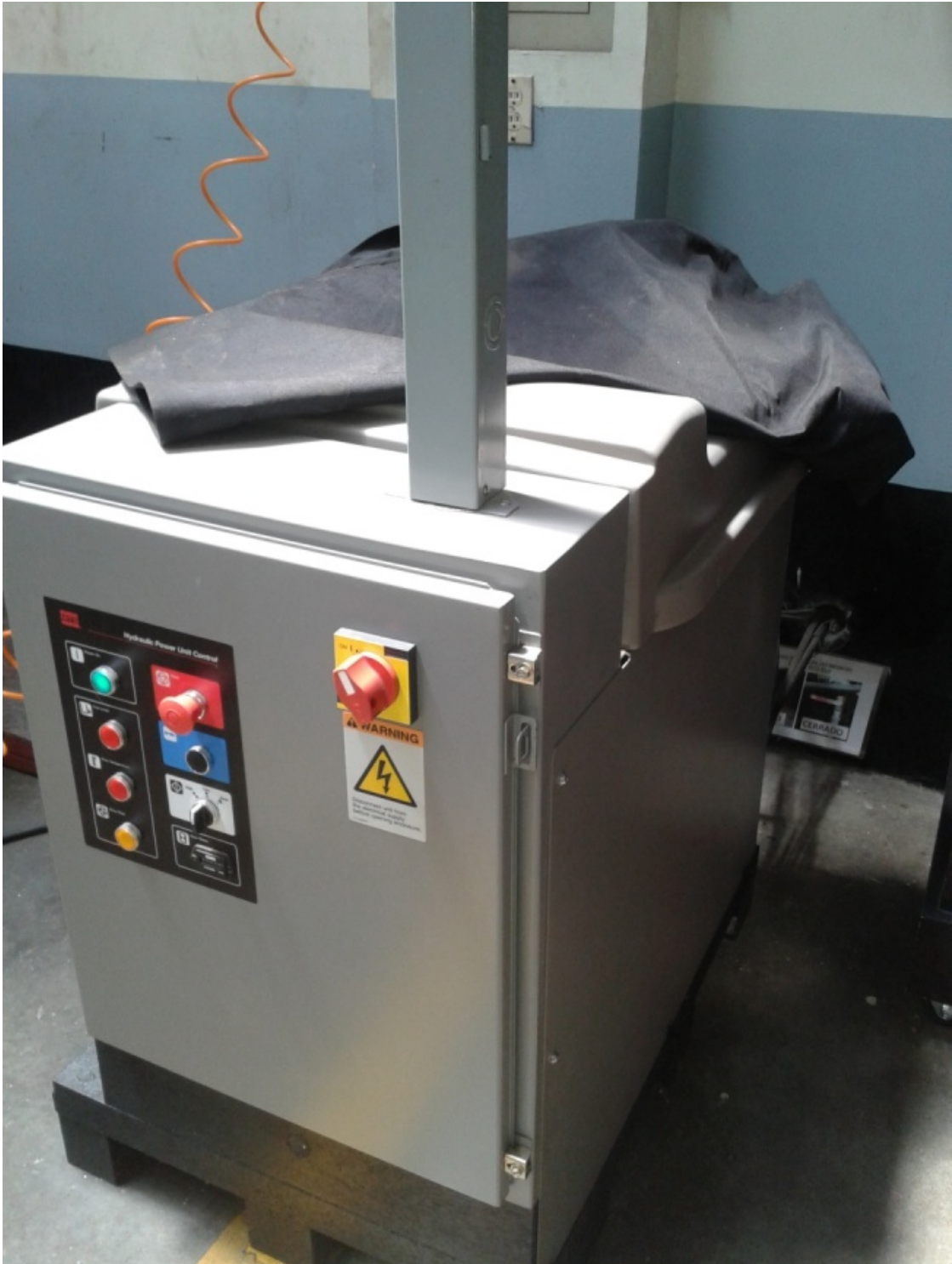
Imagen 22. HPU marca MTS® modelo 505.07 instalada en el laboratorio de fuerza del LanammeUCR.
