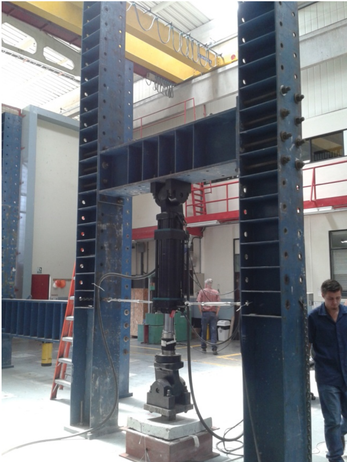
Imagen 21. Celda de carga hidráulica para pruebas de tracción y compresión en materiales marca MTS® tipo universal instalada en el laboratorio de estructura civil del LanammeUCR.
