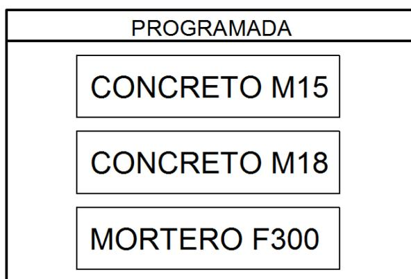
Figura 3. Visualización de la interfaz de selección de tipo de mezcla “PROGRAMADA”, mezclas establecidas por defecto. Fuente: Diseño propio.
