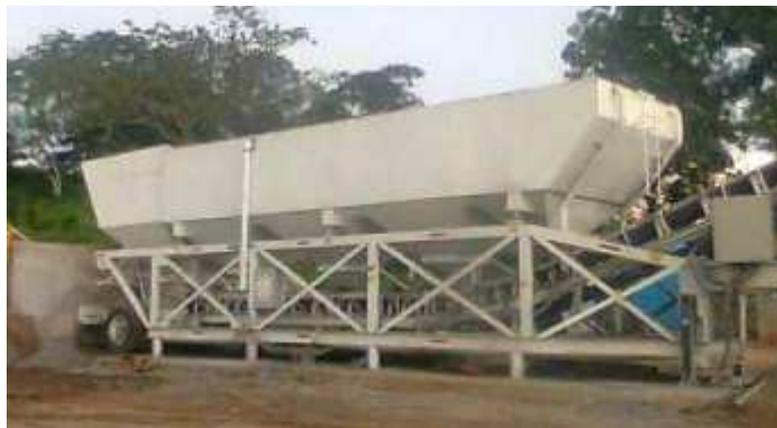
Figura 16. Ejemplo de visualización, tolvas de agregados.
