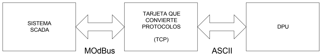
Figura 1.3 Diagrama de bloques de una instalación ideal entre la DPU y el sistema SCADA
