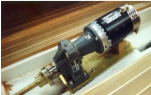
**Figura 5.3** Montaje de motor eléctrico interno
