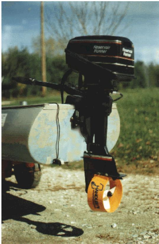
**Figura 5.5** Motor fuera de borda eléctrico
