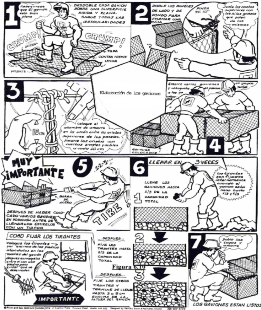
Figura 19. Proceso constructivo de los gaviones. (Suárez, 1993).
