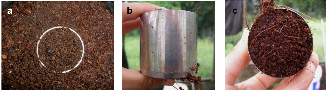
Figura 5. Metodología empleada en la determinación de densidad aparente. a) se introduce el cilindro al sustrato, b) se saca el cilindro, c) se lleva al laboratorio para ser secado.
