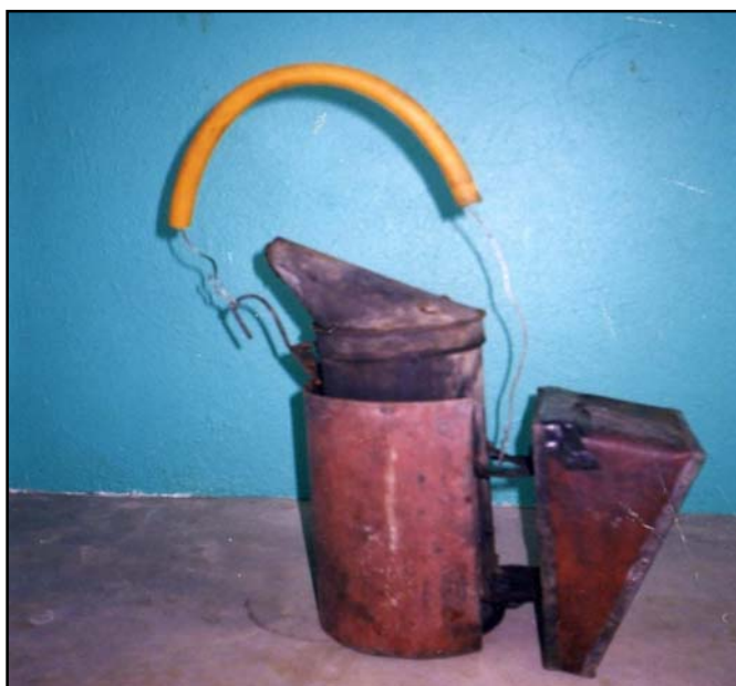
Figura 5. Bomba de apicultura empleada para la aplicación de humo de bagazo de caña ( Saccharum.officinarum ) en experimento sobre alternativas orgánicas para inducir la floración en piña ( Ananas comosus ). Finca El Tremedal S.A. Venecia, San Carlos. 2004.
