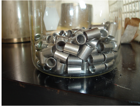
Figura 16. Cilindros de acero inoxidable recomendados en la metodología USP para llevar a cabo la prueba de Potencia Microbiológica de antibióticos.
