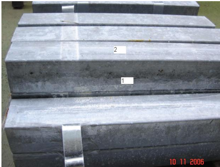
Figura 3.10: formación de oxidación blanca en las caras expuestas y no expuestas de los tubos.
