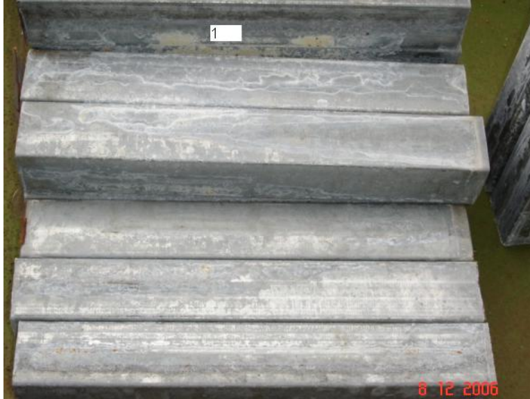
Figura 3.15: formaciones de corrosión en los sectores internos del paquete de tubos.
