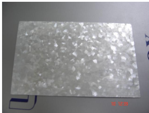
Figura 3.31: Fotografía de probeta decapada
