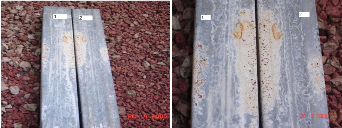
Figura 3.5 y 3.6: Formación de corrosión en las caras Internas del rollo de tubos
