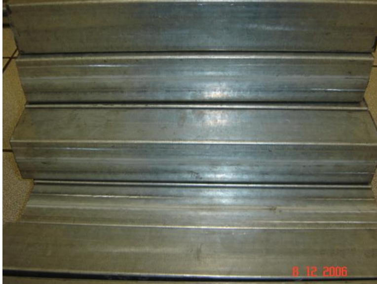
Figura 3.18: condiciones de las caras internas de los tubos en el paquete
