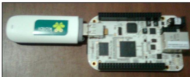
**Figura 9.** Módem USB Huawei E173 conectado con tarjeta Beaglebone
