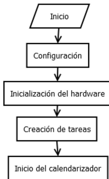
**Figura 14.** Main del software de los nodos
