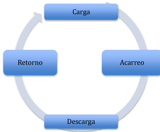
Figura 8. Ciclo de trabajo para movimiento de tierras
