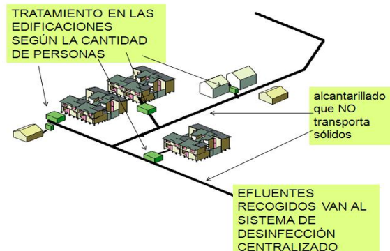
Ilustración 9: Sistema con alcantarillado de pequeño diámetro.
