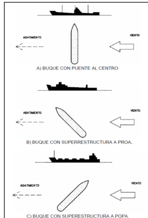
Figura 17. Giro de la embarcación alrededor del centro de gravedad en función de la superestructura (ROM 3.1-99)
