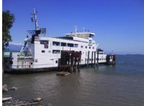
Figura 6. Ferry San Lucas II atracado en duques de alba en la Terminal de Playa Naranjo (Fuente: del Autor)
