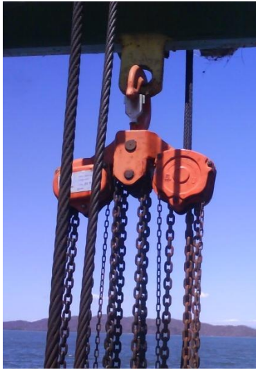
Figura 38. Detalle de catalinas metálicas y cadenas. (Fuente: del Autor)
