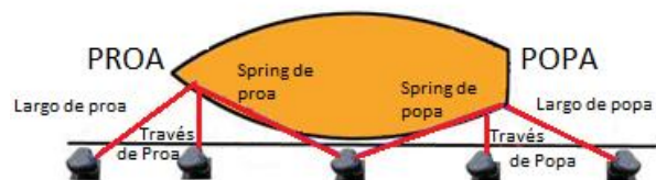
Figura 20. Nombre de las amarras de una embarcación atracada
