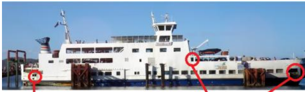
Figura 59. Ubicación de las gateras del San Lucas II por utilizar en el diseño de las amarras (Fuente: del Autor)
