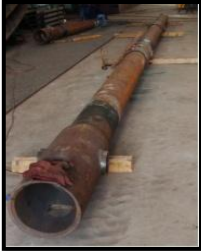
Figura 5. Pre armado de eslabones de compuerta vagón de la descarga de fondo.
