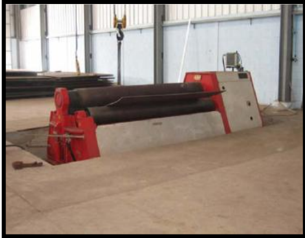
Figura 16. Dobladora con capacidad de doblar láminas de 22mm marca CALANDRA 300X22 ubicada en talleres de Honduras.
