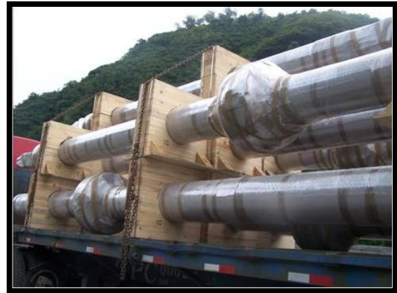
Figura 7. Pistones oleodinámicos en el momento que son transportados hacia el proyecto.
