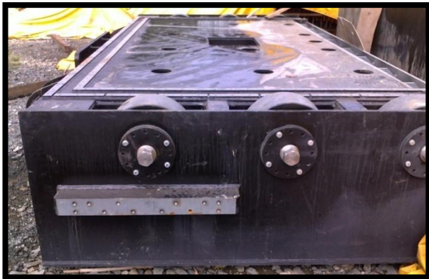
Figura 6. Compuerta vagón de la descarga de fondo. El elemento mostrado se refiere a la mitad de la compuerta.
