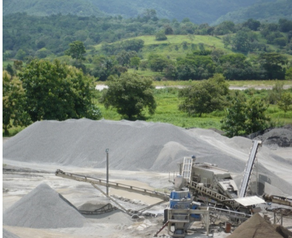
Figura 17ii. Stock de material recién extraído del río y triturado. (Fuente: El autor)
