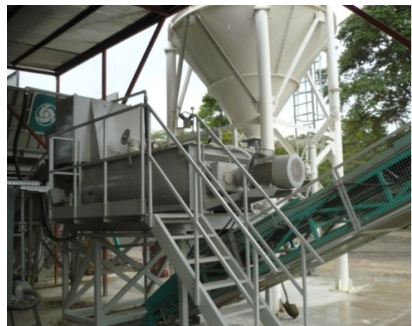
Figura 20. Planta de base estabilizada. (Fuente: El autor)
