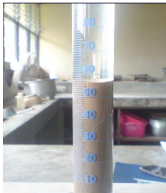
Figura 1: Prueba de precipitación de partículas de suelo suspendidas en agua.
