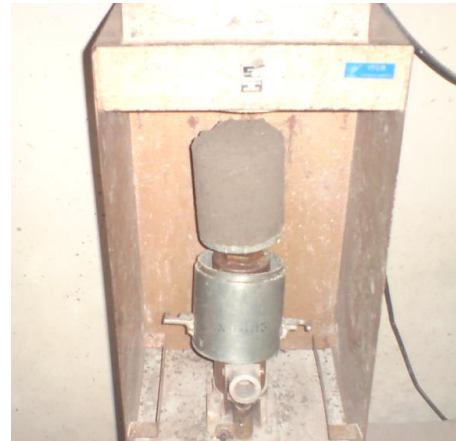
Figura 2: Desmoldeo de probeta.
