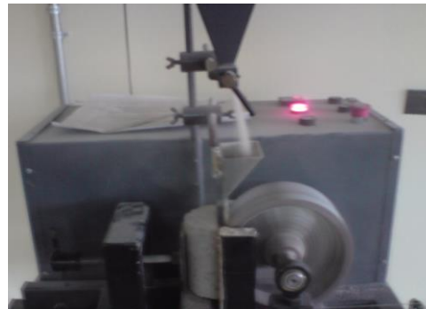
Figura 9: Falla de probeta de abrasión. Máquina colombiana para abrasión de adoquines.
