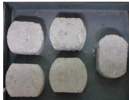
Figura 7: Probetas para abrasión de suelo-cemento.
