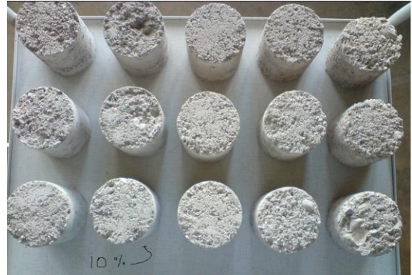
Figura 11. Probetas para la prueba Ciclos de Saturación-Secado.
