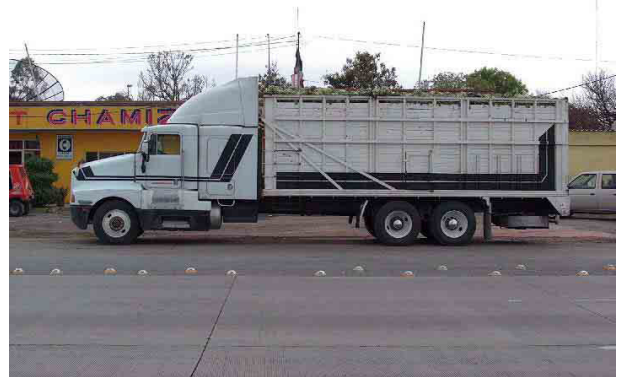
Figura 54. Configuración de vehículo C3 (eje delantero sencillo y traseros duales)
