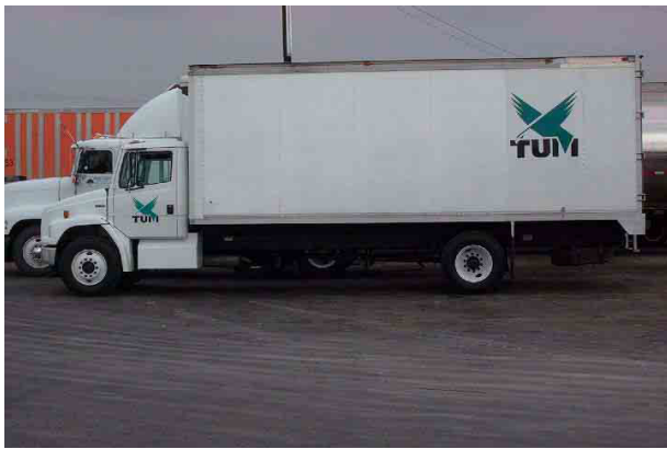
Figura 53. Configuración de vehículo C2 (eje delantero sencillo y trasero dual)
