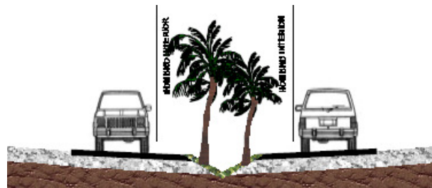
MEDIANA CON CUNETA
