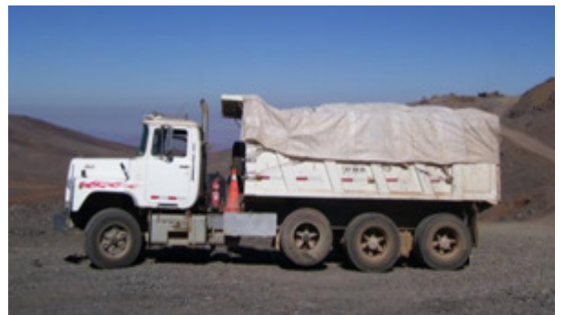
Figura 55. Configuración de vehículo C4 (eje delantero sencillo y trasero Tridem).
