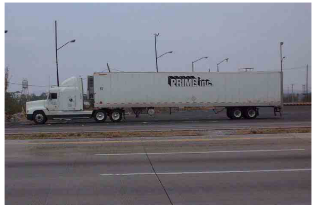
Figura 56. Configuración de vehículo T3-S2 (eje delantero sencillo y traseros duales en el tractocamión y ejes duales en el semiremolque)
