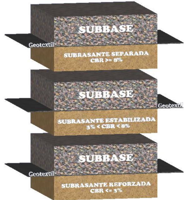
Figura 25. Función del geotextil según el CBR de subrasante
