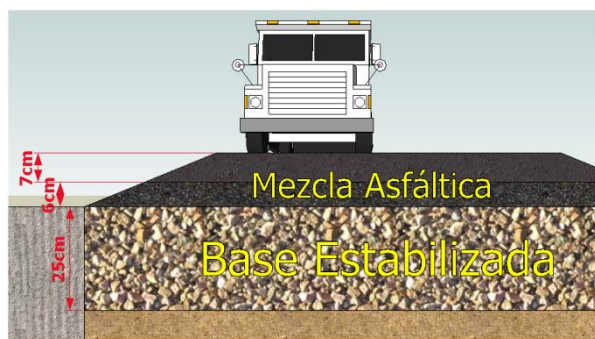
Figura 8. Espesores de mezcla asfáltica y base estabilizada
