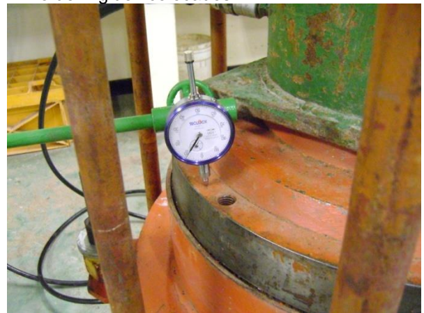
Figura 21. Detalle de los deformímetros colocados en la Placa Cabezal para determinar la deformación de los materiales.
