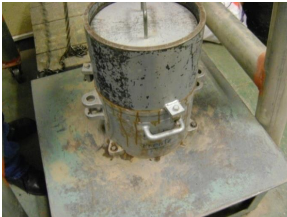
Figura 13. Densificado del material por medio de la mesa de vibrado y el peso del mazo.
