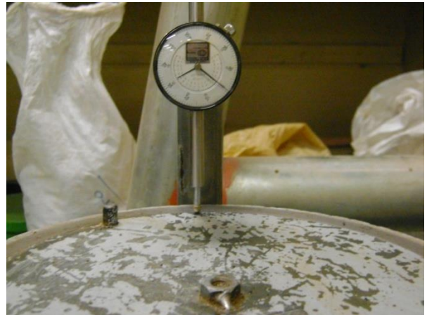
Figura 9. Determinación de las lecturas del asentamiento de los materiales posterior al tiempo de vibrado y compactación del material.
