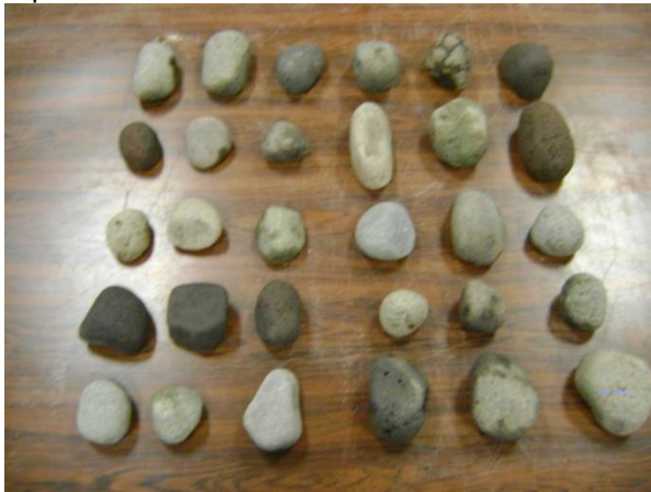
Figura 47. Muestras de 1 ½ pulgadas para ensayar en la máquina universal, estado saturado superficie seca.
