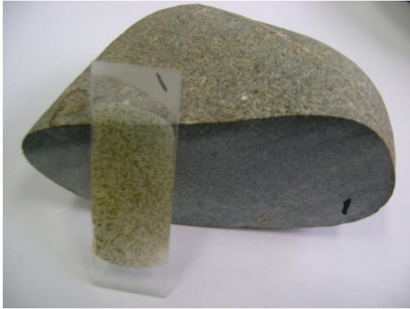
Figura 60. Muestra de Roca a la que se le realizó el Ensayo de Sección Delgada #1 para los materiales del sitio Carazo.
