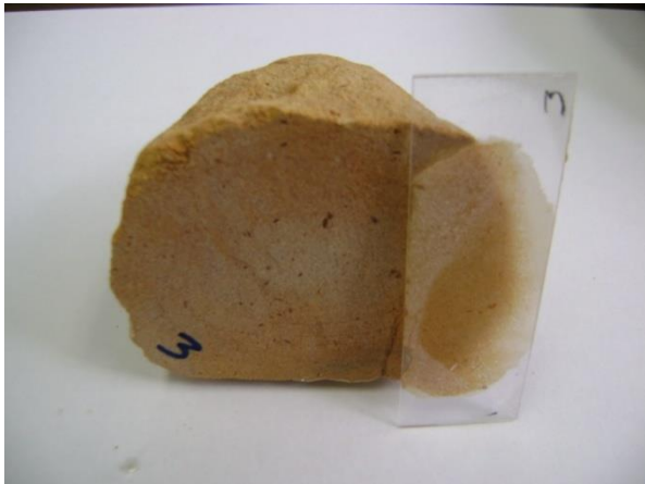
Figura 62. Muestra de Roca a la que se le realizó el Ensayo de Sección Delgada #3 para los materiales del sitio Carazo.
