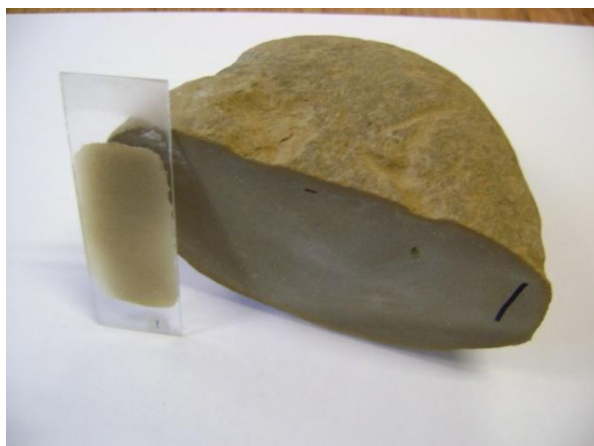
Figura 65. Muestra de Roca a la que se le realizó el Ensayo de Sección Delgada #1 para los materiales del sitio Presa.
