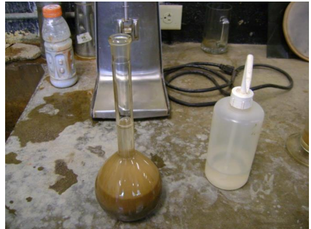
Figura 39. Llenado del picnómetro hasta la marca establecida, para su posterior pesado.
