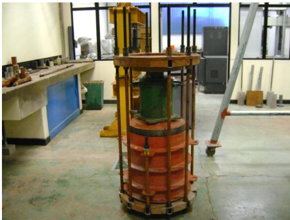
Figura 19. Armado del equipo bajo el cual se ejecuta la prueba de odómetro.
