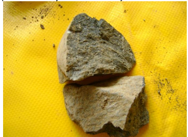
Figura 27. Ejemplo de la rotura de los granos posterior a la ejecución del ensayo de odómetro.
