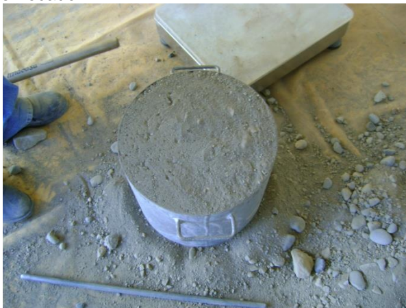
Figura 12. Enrasado del material para posteriormente realizar el pesado del mismo.
