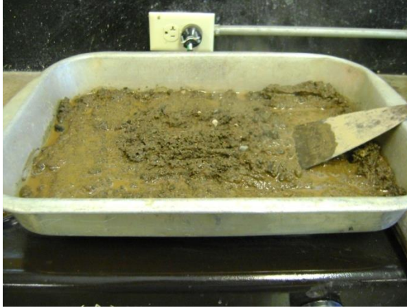
Figura 35. Determinación del punto saturado superficie seca de los materiales finos para la obtención de la gravedad específica y absorción.
