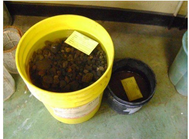
Figura 32. Saturación previo de los materiales gruesos y finos para la realización del ensayo.
