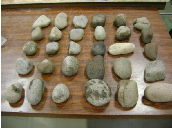
Figura 46. Muestras de 2 pulgadas para ensayar en la máquina universal, estado saturado superficie seca.
