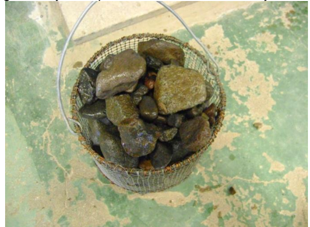
Figura 33. Colocación de los materiales dentro de la canasta para la determinación del peso sumergido de los materiales gruesos.
