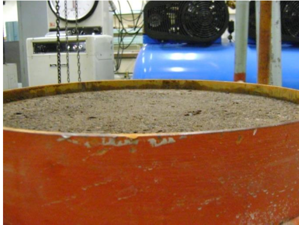
Figura 23. Asentamiento registrado de los materiales dentro del odómetro, una vez terminada la prueba.
