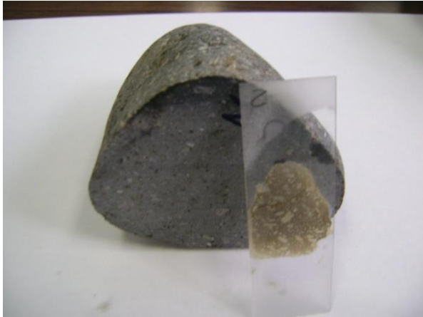
Figura 61. Muestra de Roca a la que se le realizó el Ensayo de Sección Delgada #2 para los materiales del sitio Carazo.
