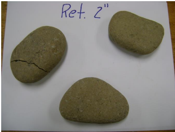
Figura 54. Ejemplo de muestras de 2 pulgadas después de alcanzar la falla de una de las rocas.
