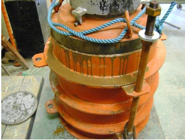
Figura 17. Colocación de la Placa Cabezal.
