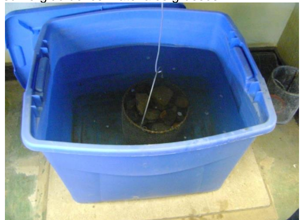
Figura 34. Determinación del peso sumergido de los materiales gruesos.
