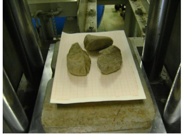
Figura 49. Colocación de la hoja inferior y las tres rocas de igual tamaño antes de ensayar.
