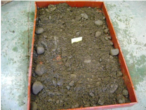
Figura 5. Saturamiento de los materiales para determinar la densidad máxima en laboratorio.
