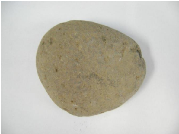
Figura 63. Muestra de roca de 2 pulgadas antes de realizar el ensayo de Carga Puntual.
