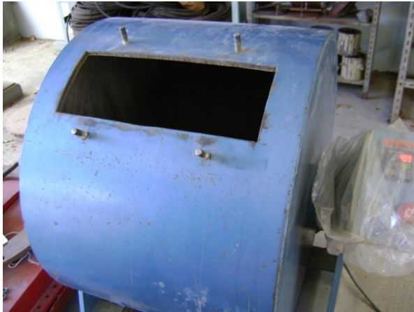
Figura 29. Máquina de Los Ángeles donde se realizó la abrasión de los materiales.
