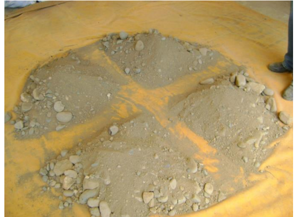
Figura 3. Separación de los materiales en cuartos, para de determinación de las curvas granulométricas.
