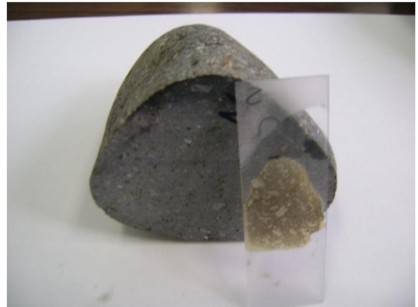
Figura 60. Ejemplo de muestra después de ensayar y obtener la clasificación mineralógica.
