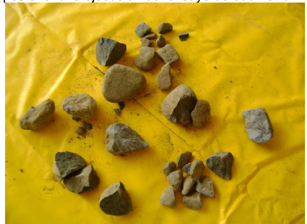
Figura 28. Ejemplos de la rotura de los granos posterior a la ejecución del ensayo de odómetro.
