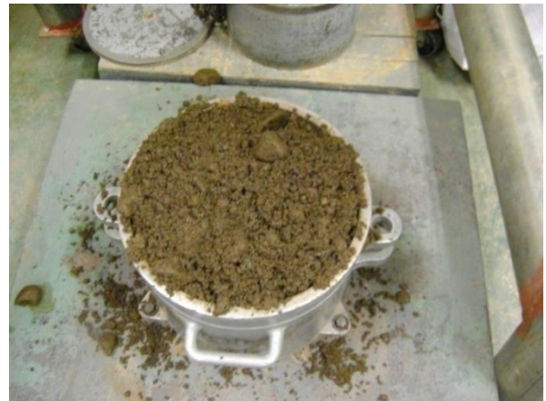
Figura 12. Colocación del material en el molde listo para ser compactado.
