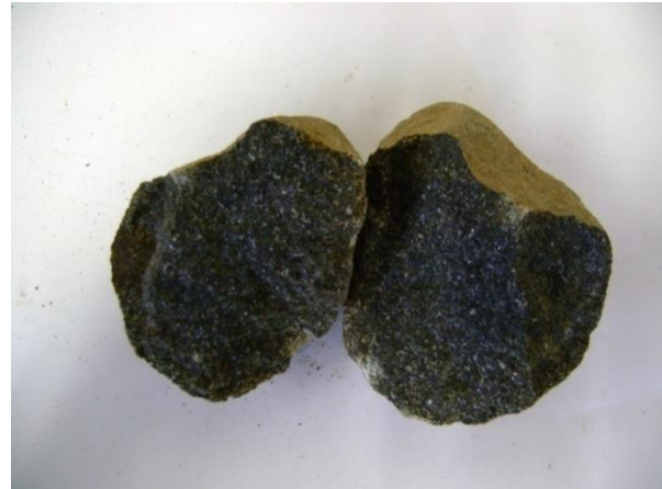
Figura 18. Roca fragmentada por la implementación de presión en sus extremos, correspondiente a materiales del sitio Carazo.
