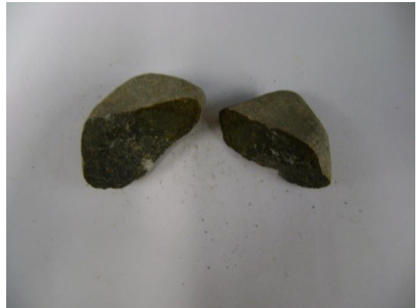
Figura 66. Muestra de roca de 1 ½ pulgadas después de realizar el ensayo de Carga Puntual.
