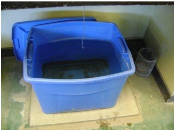
Figura 16. Determinación del Peso Sumergido para determinar la Gravedad Específica y Absorción de los gruesos.
