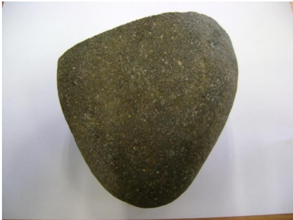
Figura 7. Muestra de Roca para realizar la Sección Delgada del sitio Presa.
