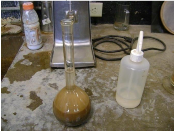
Figura 15. Picnómetro con la muestra saturada superficie seca para la determinación de la Gravedad Específica y Absorción en Finos.
