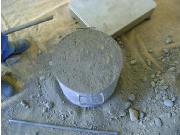
Figura 11. Peso Volumétrico Compactado y Enrasado.
