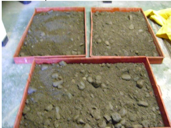
Figura 24. Extracción de los materiales del odómetro para su posterior secado al horno y determinación de su granulometría final.
