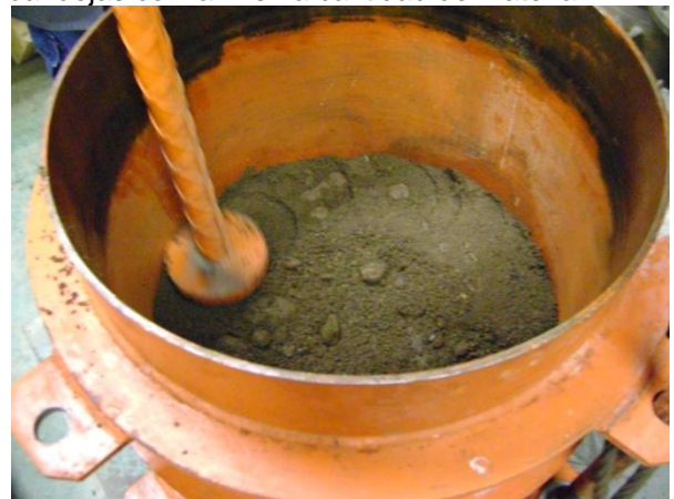
Figura 15. Colocación del material dentro del odómetro en tres capas iguales de material.
