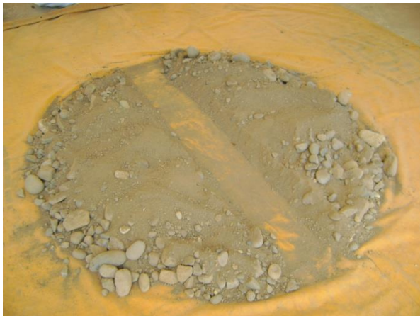
Figura 2. Proceso para la realización del cuarteo de los materiales, para la determinación de las curvas granulométricas.
