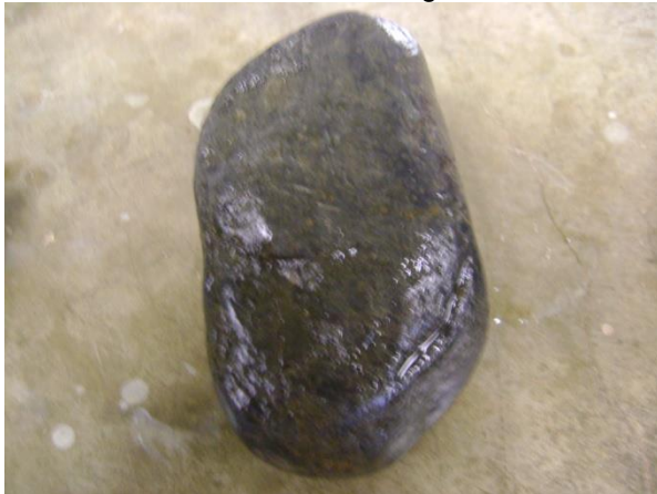
Figura 58. Ejemplo de muestra a ensayar para obtener la clasificación mineralógica de la roca.
