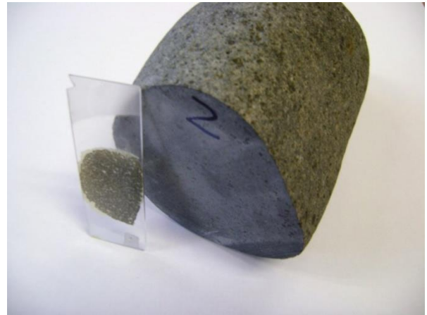
Figura 66. Muestra de Roca a la que se le realizó el Ensayo de Sección Delgada #2 para los materiales del sitio Presa.
