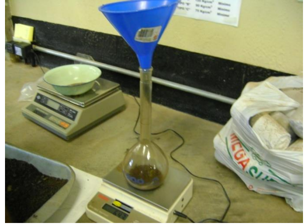
Figura 38. Introducción de los materiales finos dentro del picnómetro, para determinar la gravedad específica y absorción de los materiales.
