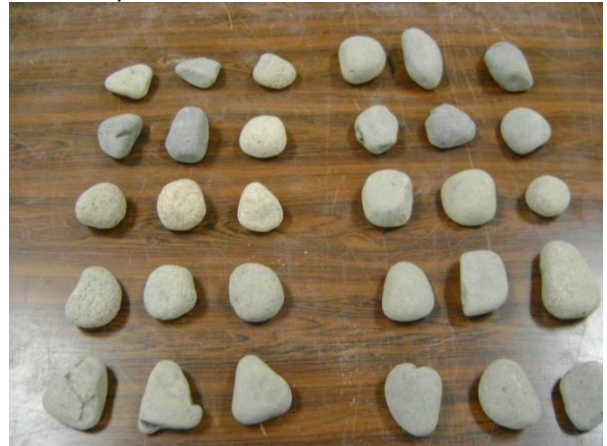
Figura 44. Muestras de 1 ½ pulgadas para ensayar en la máquina universal, estado seco.
