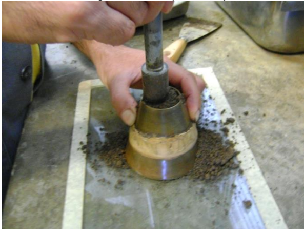
Figura 36. Determinación del punto saturado superficie seca de los materiales.
