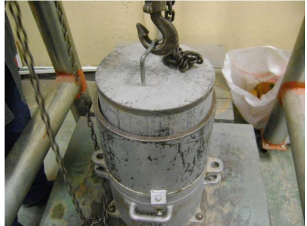
Figura 8. Colocación del mazo dentro de la camisa del cilindro, para determinar el asentamiento del material.
