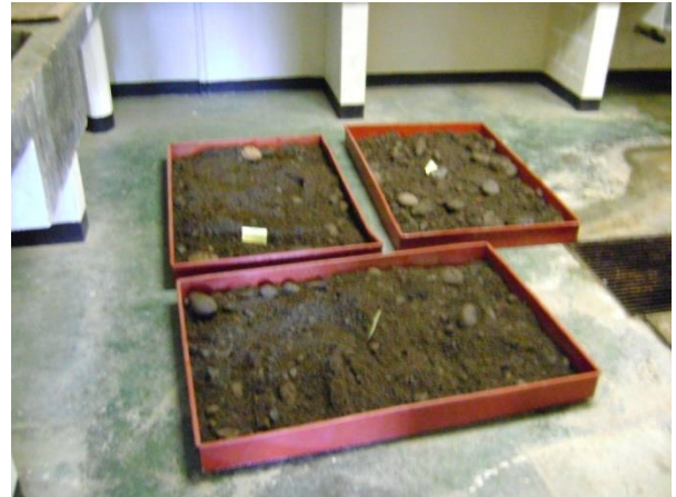
Figura 14. Preparación de los materiales a colocar en el odómetro, distribuidos en tres bandejas con la misma cantidad de material.
