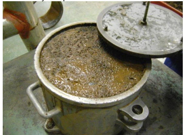
Figura 10. Finalización de la prueba de densidad relativa con la extracción del material dentro del cilindro.
