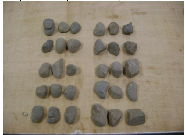
Figura 45. Muestras de 1 pulgada para ensayar en la máquina universal, estado seco.
