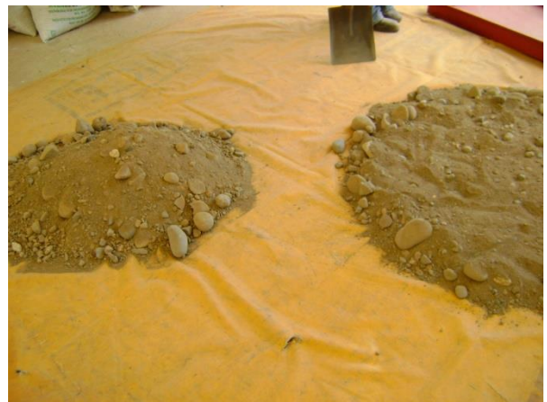
Figura 4. Reducción de la muestra para la determinación de la granulometría de los materiales de las distintas trincheras.
