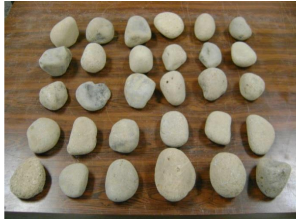
Figura 43. Muestras de 2 pulgadas para ensayar en la máquina universal, estado seco.
