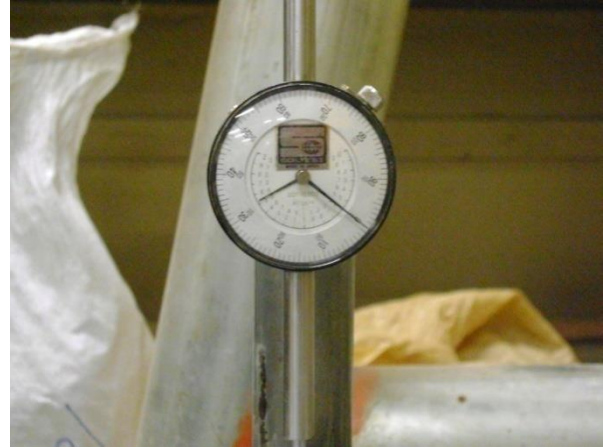
Figura 14. Colocación de los Deformímetros para medir el asentamiento del material.
