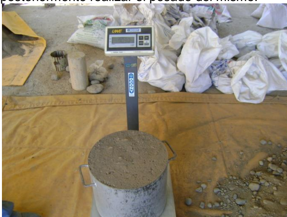
Figura 13. Determinación del peso del material, para determinar el peso volumétrico.
