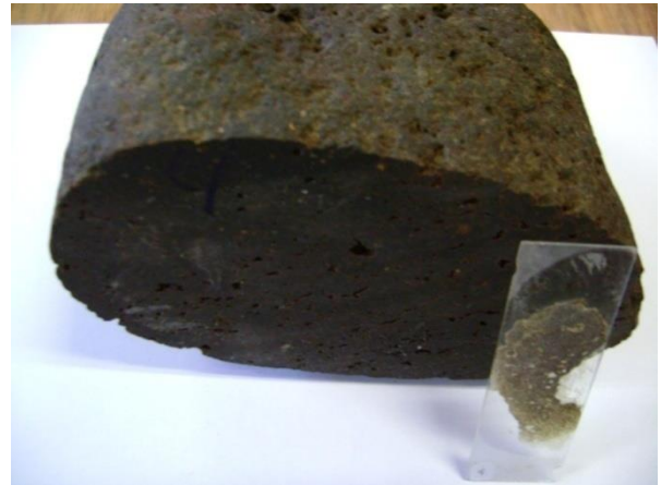
Figura 68. Muestra de Roca a la que se le realizó el Ensayo de Sección Delgada #4 para los materiales del sitio Presa.
