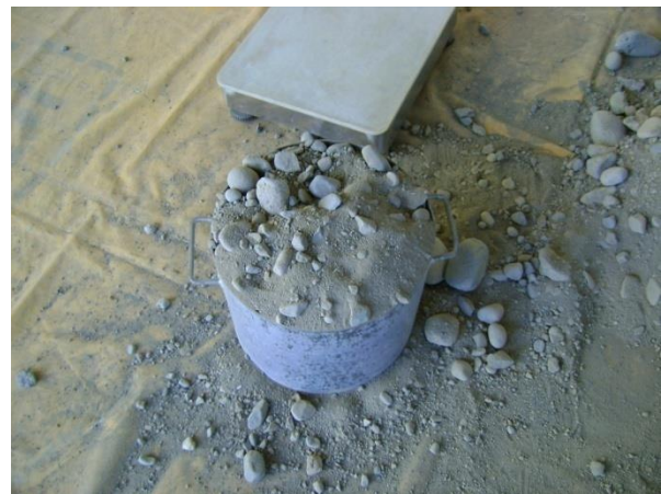
Figura 10. Peso Volumétrico Suelto del Material.
