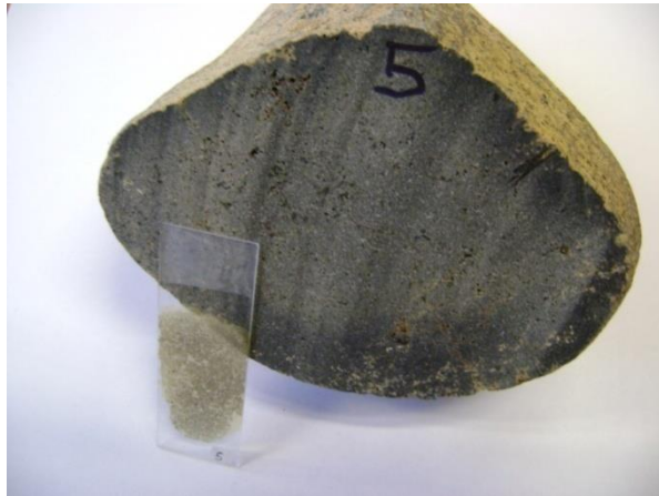
Figura 69. Muestra de Roca a la que se le realizó el Ensayo de Sección Delgada #5 para los materiales del sitio Presa.
