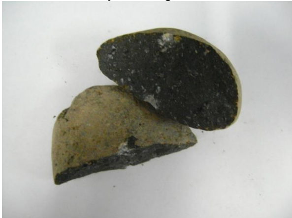
Figura 64. Muestra de roca de 2 pulgadas después de realizar el ensayo de Carga Puntual.
