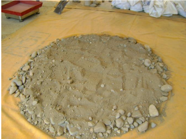
Figura 1. Cuarteo del material proveniente de las distintas trincheras analizadas de los sitios en estudio.
