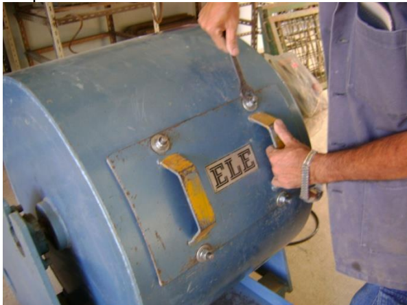
Figura 31. Sellado de la máquina para la ejecución de la prueba.
