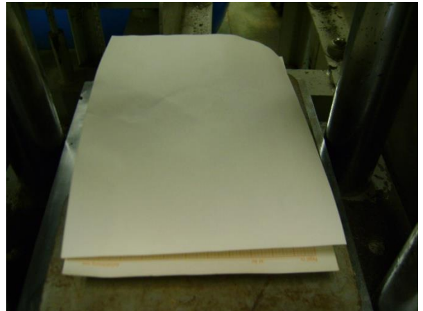
Figura 50. Colocación de la hoja superior sobre las tres rocas de igual tamaño antes de ensayar.
