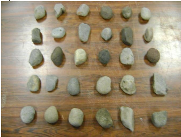
Figura 48. Muestras de 1 pulgada para ensayar en la máquina universal, estado saturado superficie seca.
