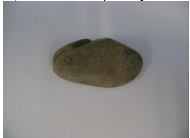
Figura 67. Muestra de roca de 1 pulgada antes de realizar el ensayo de Carga Puntual.
