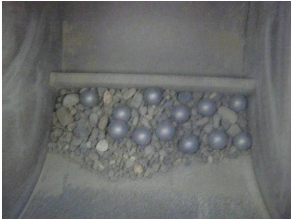
Figura 30. Colocación del material dentro de la máquina con los 12 balines de acero.
