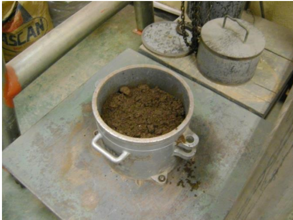
Figura 6. Colocación de los materiales, dentro del cilindro de ejecución, para determinar la densidad máxima de los materiales.
