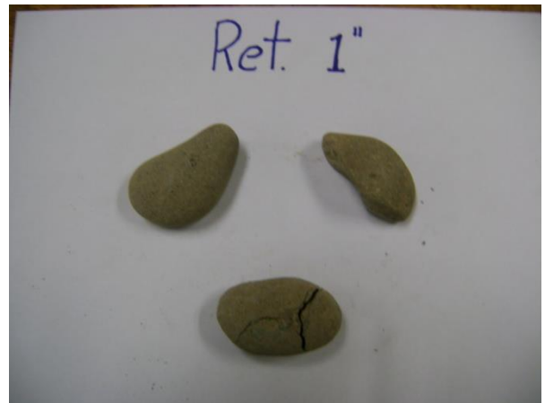
Figura 56. Ejemplo de muestras de 1 pulgada después de alcanzar la falla de una de las rocas.
