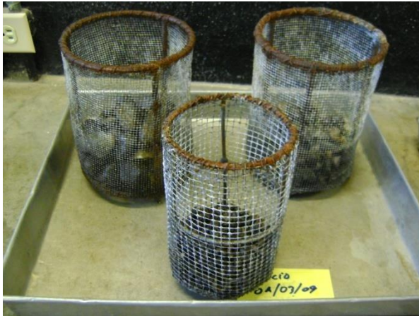
Figura 40. Colocación de los materiales gruesos en las respectivas mallas para iniciar la prueba.
