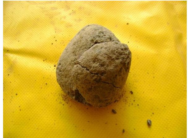
Figura 26. Ejemplo de la rotura de los granos posterior a la ejecución del ensayo de odómetro.
