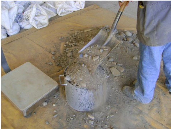
Figura 11. Llenado del cilindro para la determinación del peso volumétrico para el enrocado.
