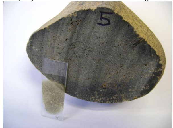
Figura 61. Ejemplo de muestra después de ensayar y obtener la clasificación mineralógica.
