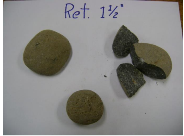
Figura 55. Ejemplo de muestras de 1 ½ pulgadas después de alcanzar la falla de una de las rocas.
