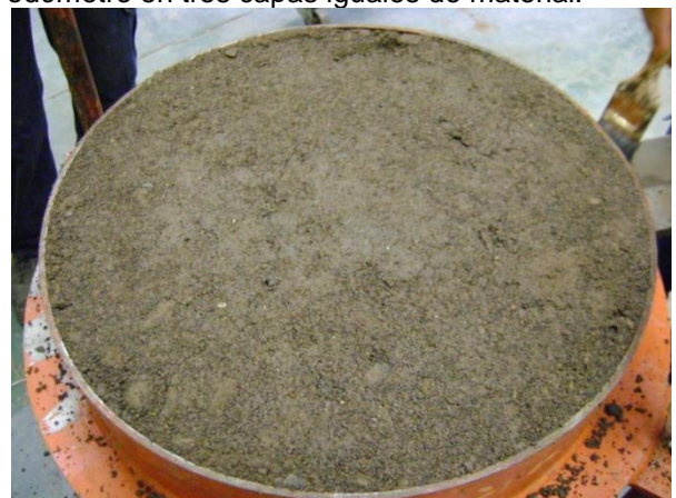
Figura 16. Llenado del Odómetro y su respectivo enrasado, con los materiales en estudio.
