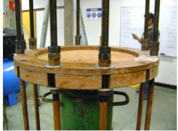
Figura 20. Detalle de la Placa Superior y del Anillo de Rigidez colocados.
