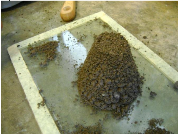
Figura 37. Obtención del cono truncado con los materiales para determinar el punto saturado superficie seca de los materiales.
