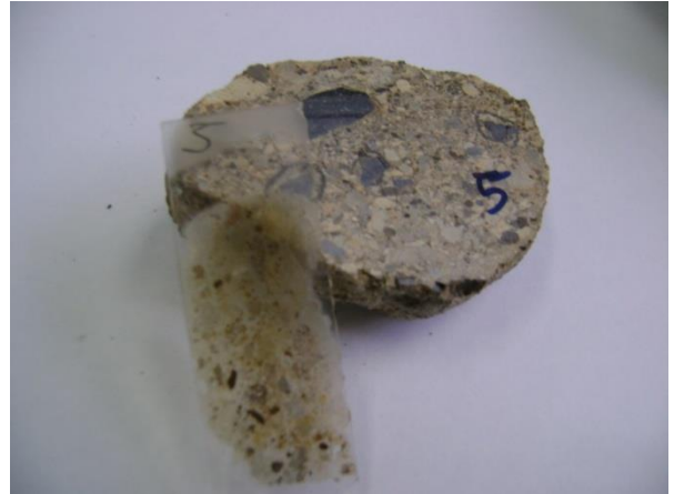
Figura 64. Muestra de Roca a la que se le realizó el Ensayo de Sección Delgada #5 para los materiales del sitio Carazo.
