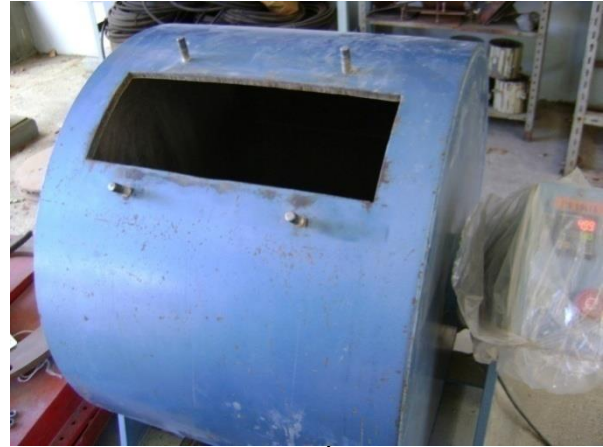
Figura 9. Máquina de los Ángeles instalada en el Laboratorio de Materiales del ICE.
