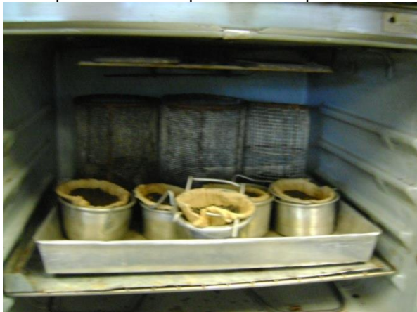
Figura 42. Colocación de los materiales en el horno para su ciclo de secado.
