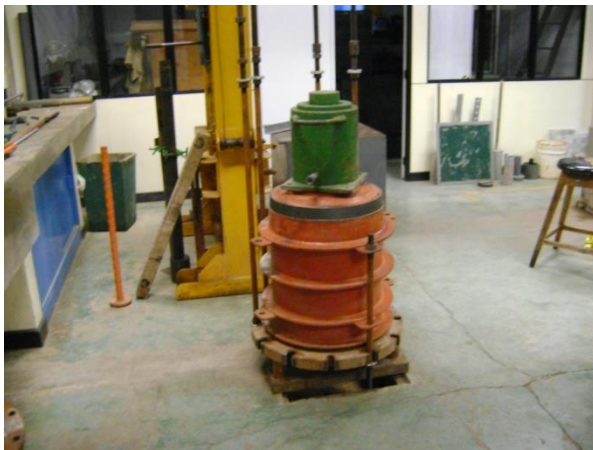
Figura 18. Colocación de la Gata Hidráulica y de los pernos de soporte de la Placa Superior.
