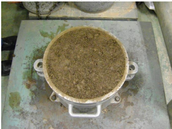
Figura 7. Enrasado de los materiales dentro del cilindro para obtener la densidad del material.
