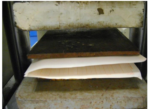
Figura 51. Colocación de la placa superior distribuidora de los esfuerzos transmitidos sobre las tres rocas a ensayar.
