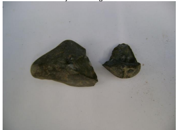
Figura 68. Muestra de roca de 1 pulgada después de realizar el ensayo de Carga Puntual.
