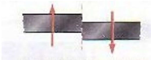
Figura 19. Esquema de esfuerzos en cortante de una viga.
