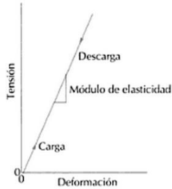
Figura 5. Curva de esfuerzo (tensión) y deformación.
