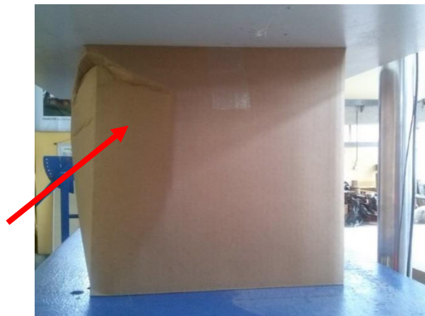
Figura 33. Falla de caja en las pruebas de compresión
