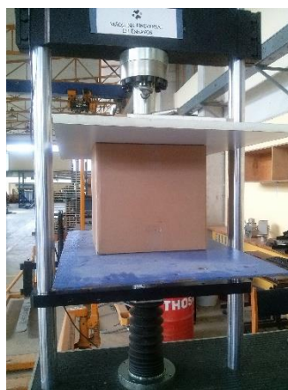
Figura 17. Equipo utilizado en las pruebas de compresión.
