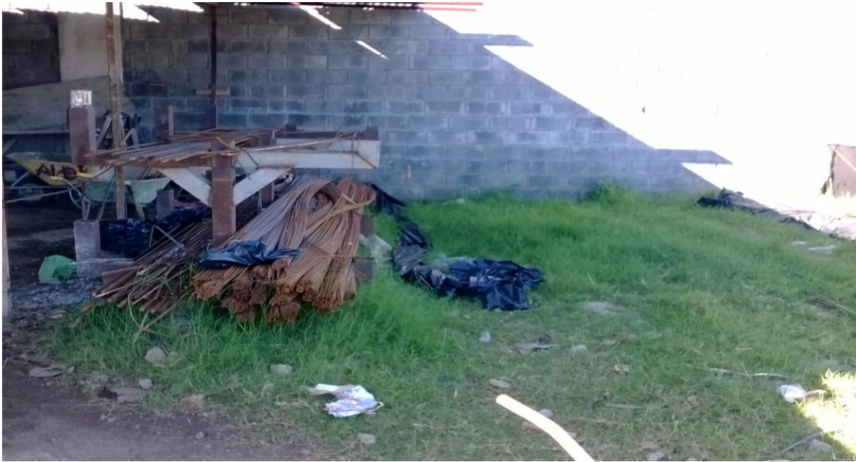
Figura N°23. Varillas corroídas – Lote10A. Marzo, 2014
