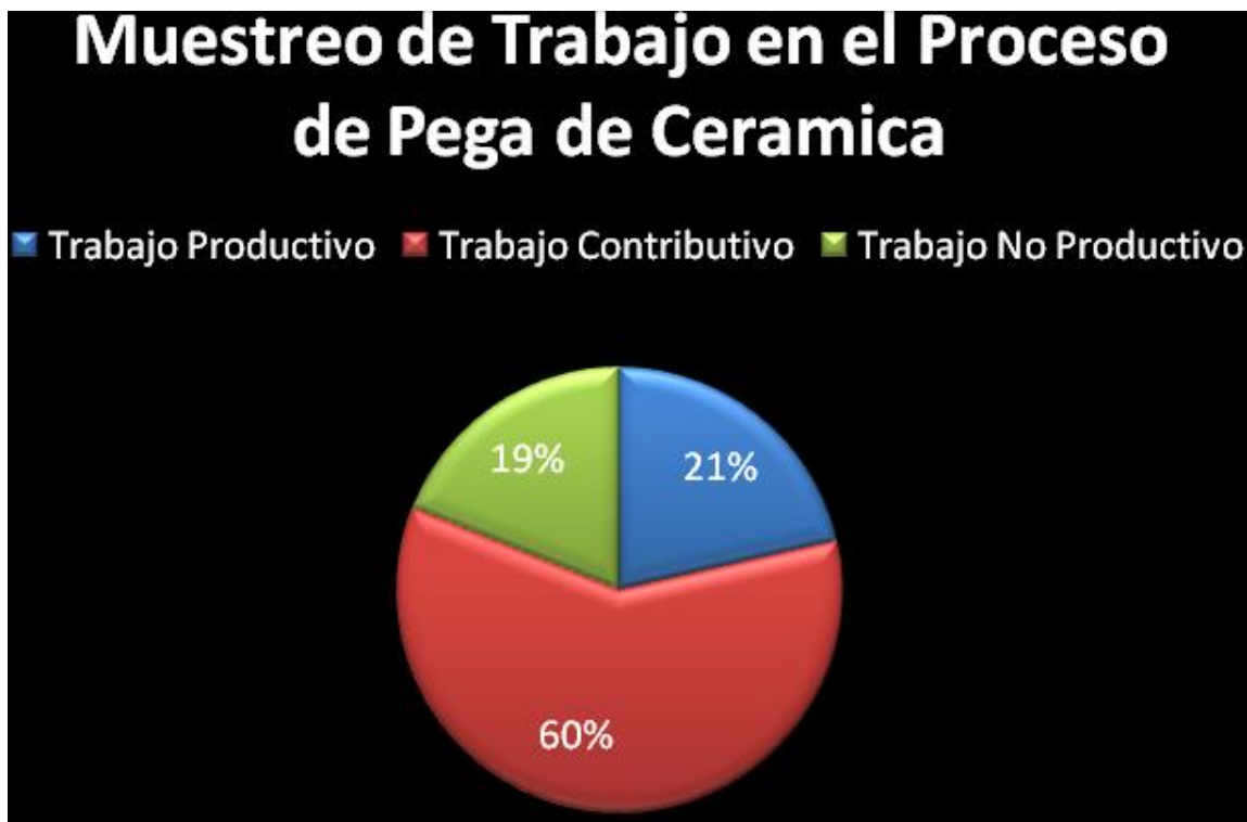
Figura N°29. Elaboración propia. Gráfico del muestreo de trabajo para el proceso de pega de Cerámica.
