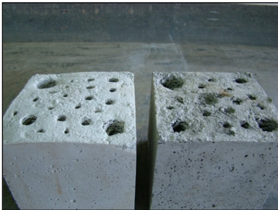
Imagen 14. Probetas después del ensayo del tiempo de fragua
