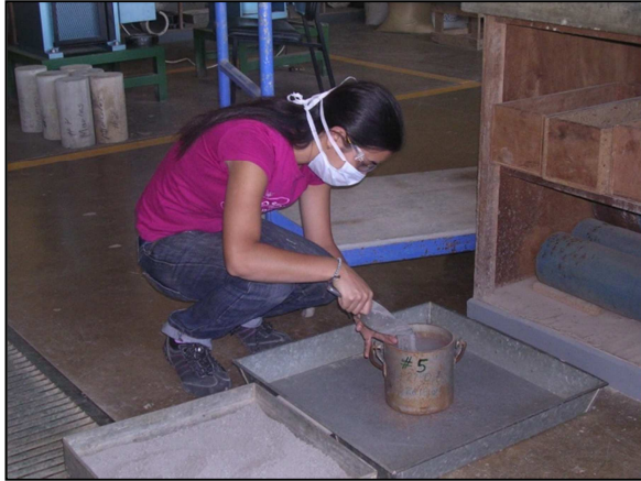
Imagen 27. Ensayo Peso Unitario
