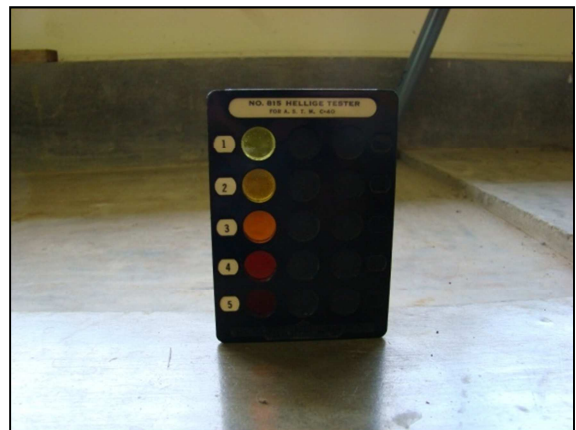
Imagen 29. Tabla de Gardner Ensayo Colorimetría
