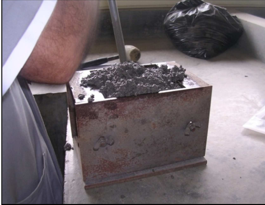
Imagen 12. Probeta de mortero para determinar el tiempo de fragua
