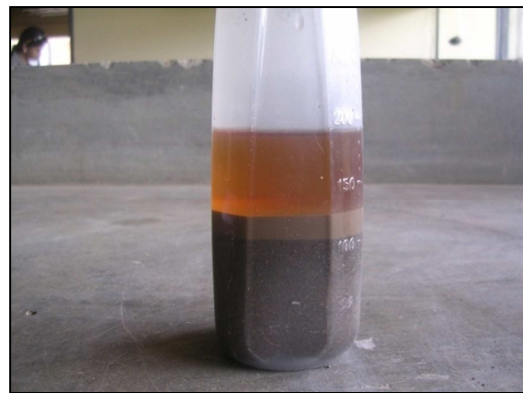
Imagen 30. Ensayo Colorimetría Proyecto 5.
