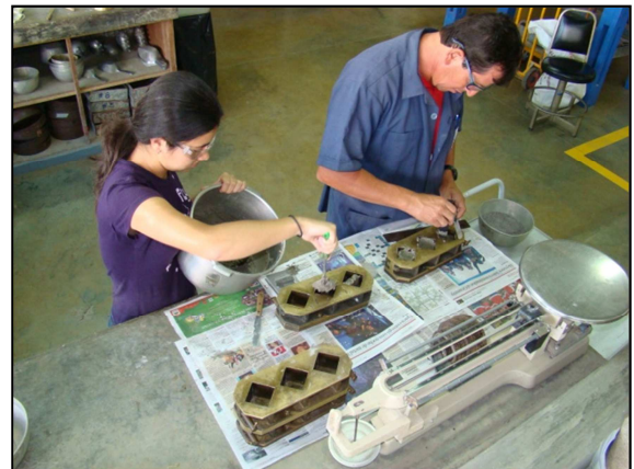
Imagen 15. Elaboración de cubos en el laboratorio
