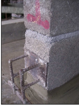
Imagen 8. Copeo de prismas con yeso-cemento
