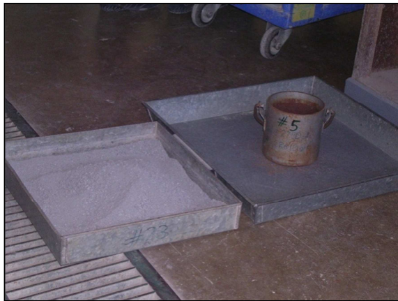
Imagen 28. Equipo Ensayo Peso Unitario
