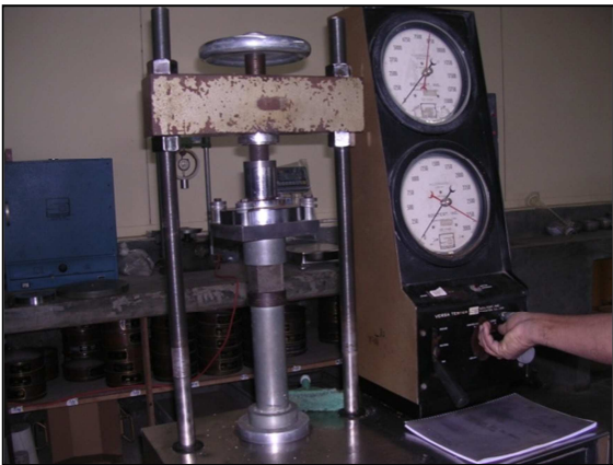
Imagen 5. Resistencia a la compresión de cubos de mortero
