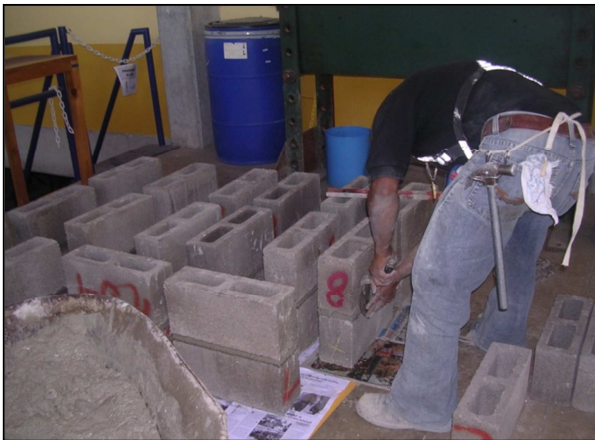
Imagen 9. Se fabricaron 5 prismas para cada tipo de mortero
