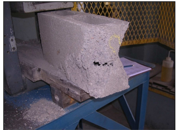
Imagen 37. Resistencia a la compresión del bloque de concreto
