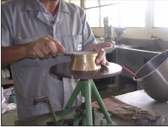
Imagen 17. Ensayo para determinar el flujo del mortero
