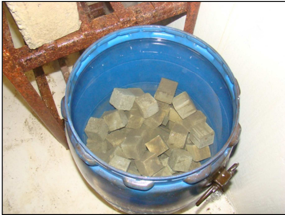
Imagen 4. Curado de cubos de mortero hasta el día de falla
