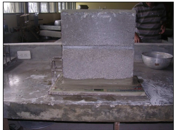
Imagen 7. Proceso de capeo en prismas
