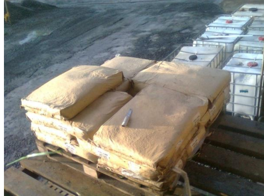
Figura 7. Tarima con los sacos de fibra metálica para el concreto, planta Pozzuolli P.H.R.
