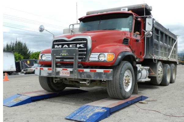
Figura 69 Pesaje de vagonetas.
