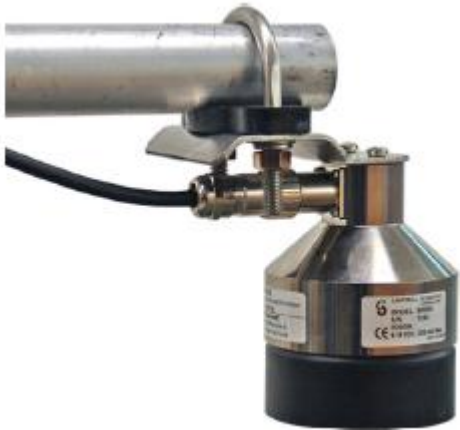
Figura 34. Instalación Sensor ultrasónico SR50A.
