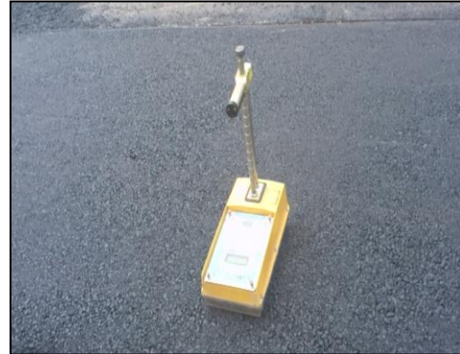
Figura 86. Medición de la compactación utilizando densímetro nuclear (Autor, 2012)
