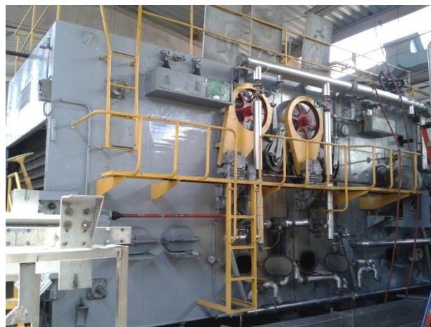
Figura 4.4. Lavadora de envases de vidrio San Martin.
