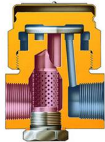
Figura 3.5. Trampa de vapor tipo disco.
