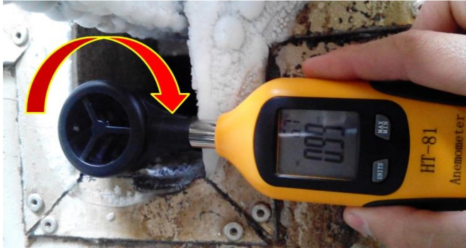
Figura. 15. Anemómetro en la salida de aire
