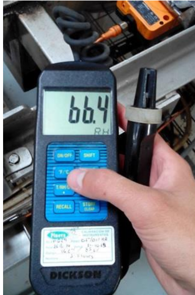
Figura. 14. Higroscopio para medir humedad relativa
