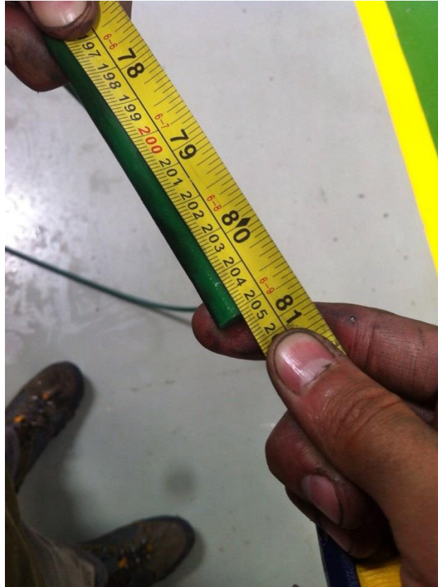
Figura. 38. Medición de liga con longitud incorrecta
