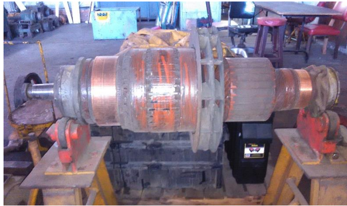
Descripción: Armadura de excitador y generador auxiliar
