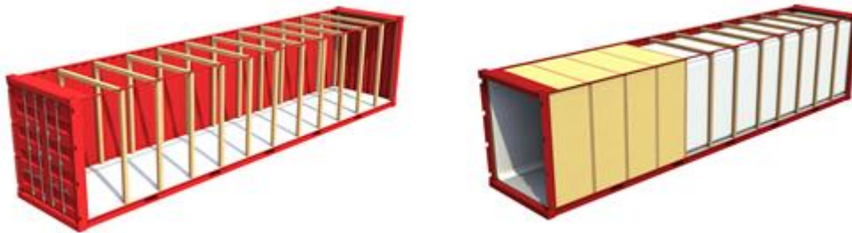
Figura 28. Esqueleto de Madera, capa aislante y recubrimiento interno de metal
