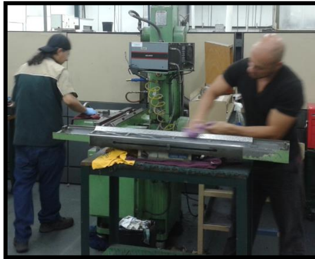
Figura 12. Implementación de la inspección trimestral
