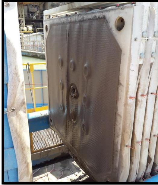
**Figura 2.5.** Placas y telas filtrantes del filtro.
