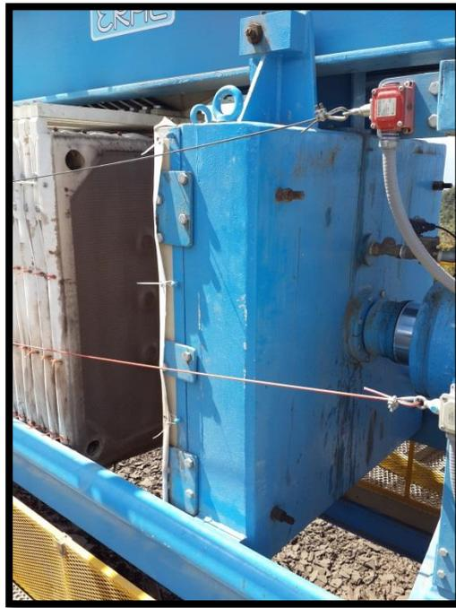
**Figura 2.3.** Cabezal móvil del filtro.
