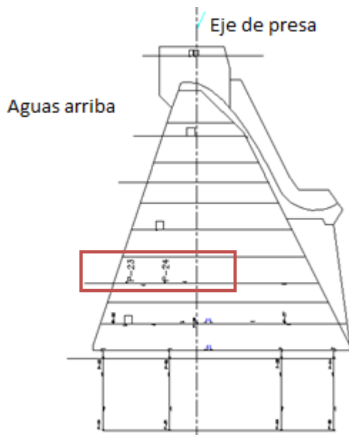
Figura 77. Ubicación de los piezómetros 23 y 24 en la elevación 1120 m.s.n.m., estación 0+158. Fuente Emilia Ramírez. 1
