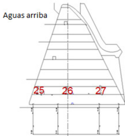
Figura 70. Ubicación de los piezómetros en la elevación 1105 m.s.n.m., estación 0+158. Fuente Emilia Ramírez, ICE, Departamento de Auscultación, 2009.
