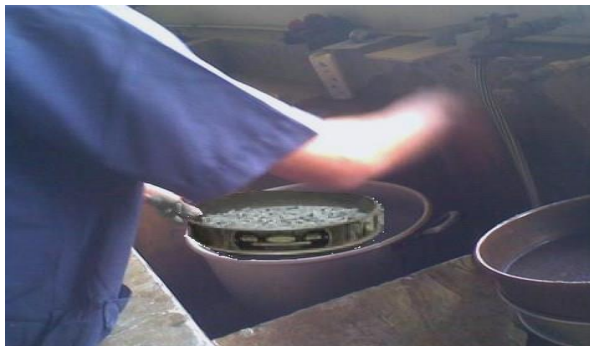
Figura 14. Lavado del material extraído de la máquina Los Ángeles.
