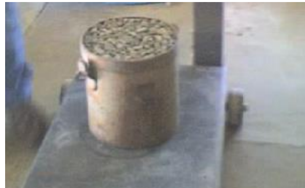
Figura 12. Determinación de la masa del recipiente mas el material.
