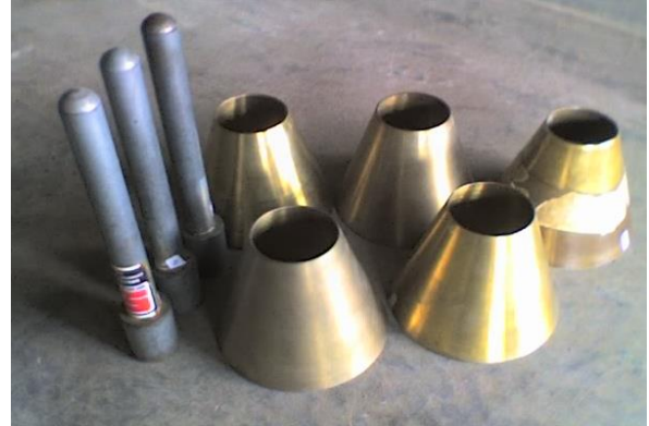
Figura 4. Moldes y apisonadores para prueba de gravedad específica en agregado fino.
