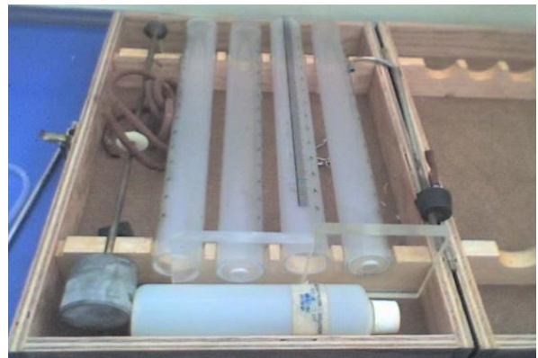
Figura 8. Equipo de prueba Equivalente de arena
