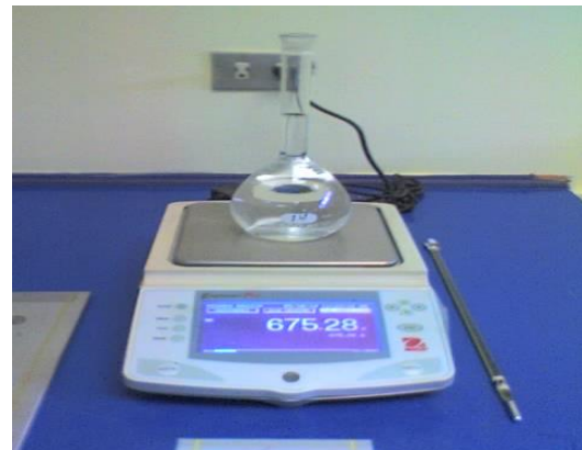
Figura 5. Verificación de picnómetros.
