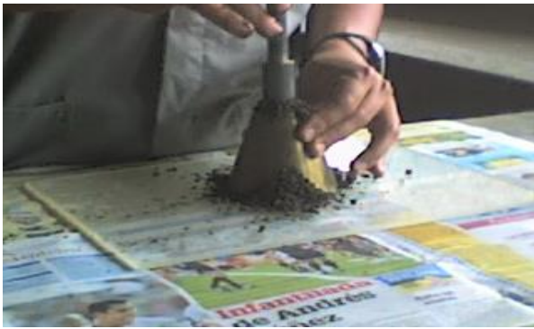
Figura 18. Prueba de humedad en la superficie (prueba del cono).
