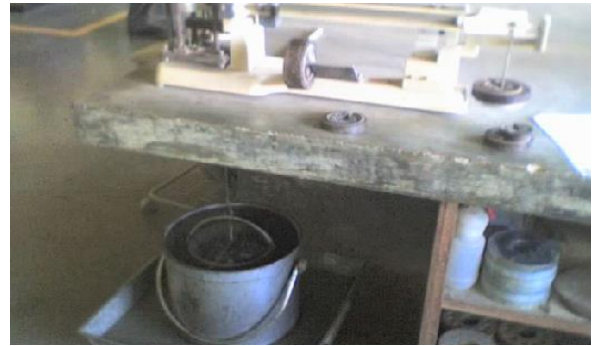
Figura 16. Determinación de la masa sumergida del material.
