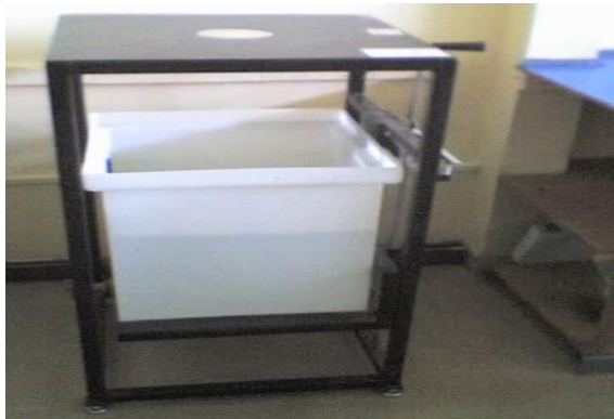
Figura 3. Mesa para prueba de gravedad específica de agregado grueso.
