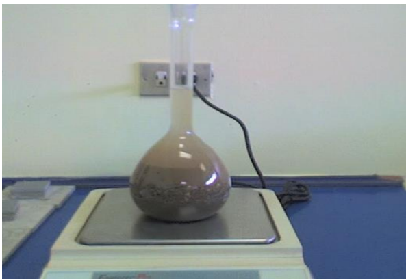
Figura 19. Determinación de masa del picnómetro con la muestra y agua hasta la marca de calibración.
