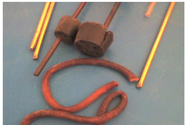
Figura 9. Equipo menor de prueba Equivalente de arena.
