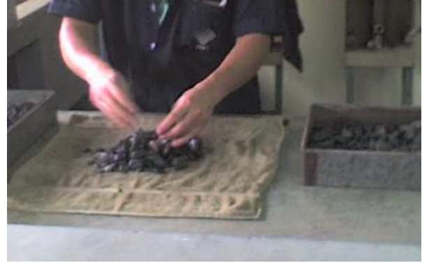
Figura 15. Eliminación del exceso de agua para lograr la condición saturada superficie seca.
