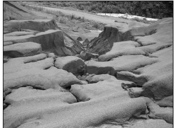
Foto 19. Acopio de agregados (arena) dañado por la lluvia y las condiciones de la zona del apilamiento
