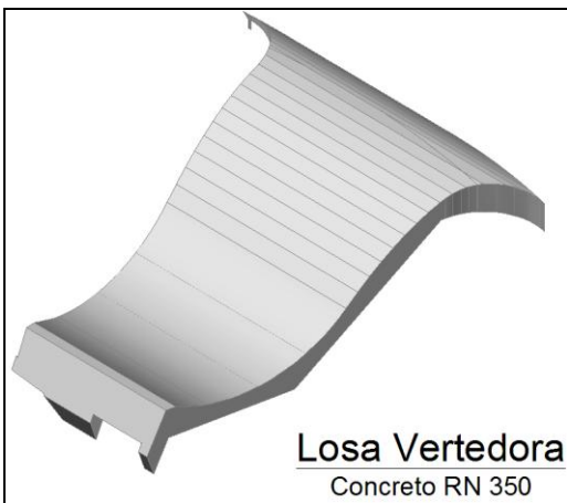
Figura 42. Losa vertedora de la contra presa
