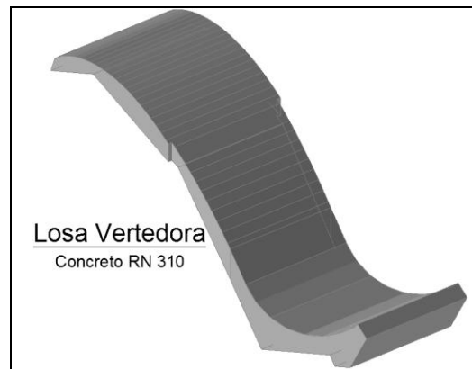
Figura 44. Losa del vertedor
