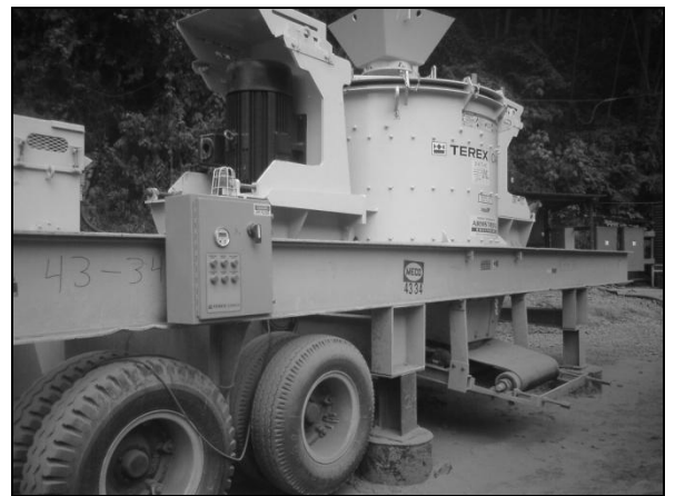
Foto 20. Impactor de eje vertical VSI (Vertical Shaft Impactor)
